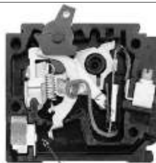
Contacto en posición abierto
