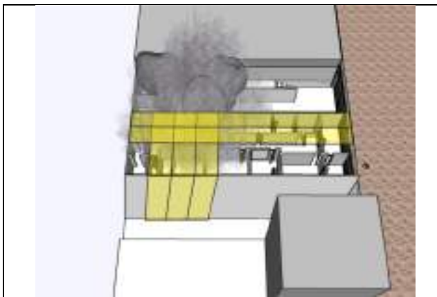
Ilustración 222 - Área de Origen determinada geométricamente a partir de los videos iniciales del incendio- Realizada con SketchUp - EDOC
