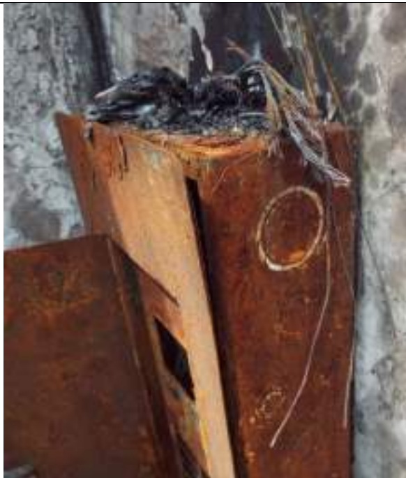
Ilustración 132 Alteración de la escena por la ausencia de Cables o conductores eléctricos que fueron retirados de la escena y que salían de la caja de tacos o disyuntores - EDOC - 25/09/2020
