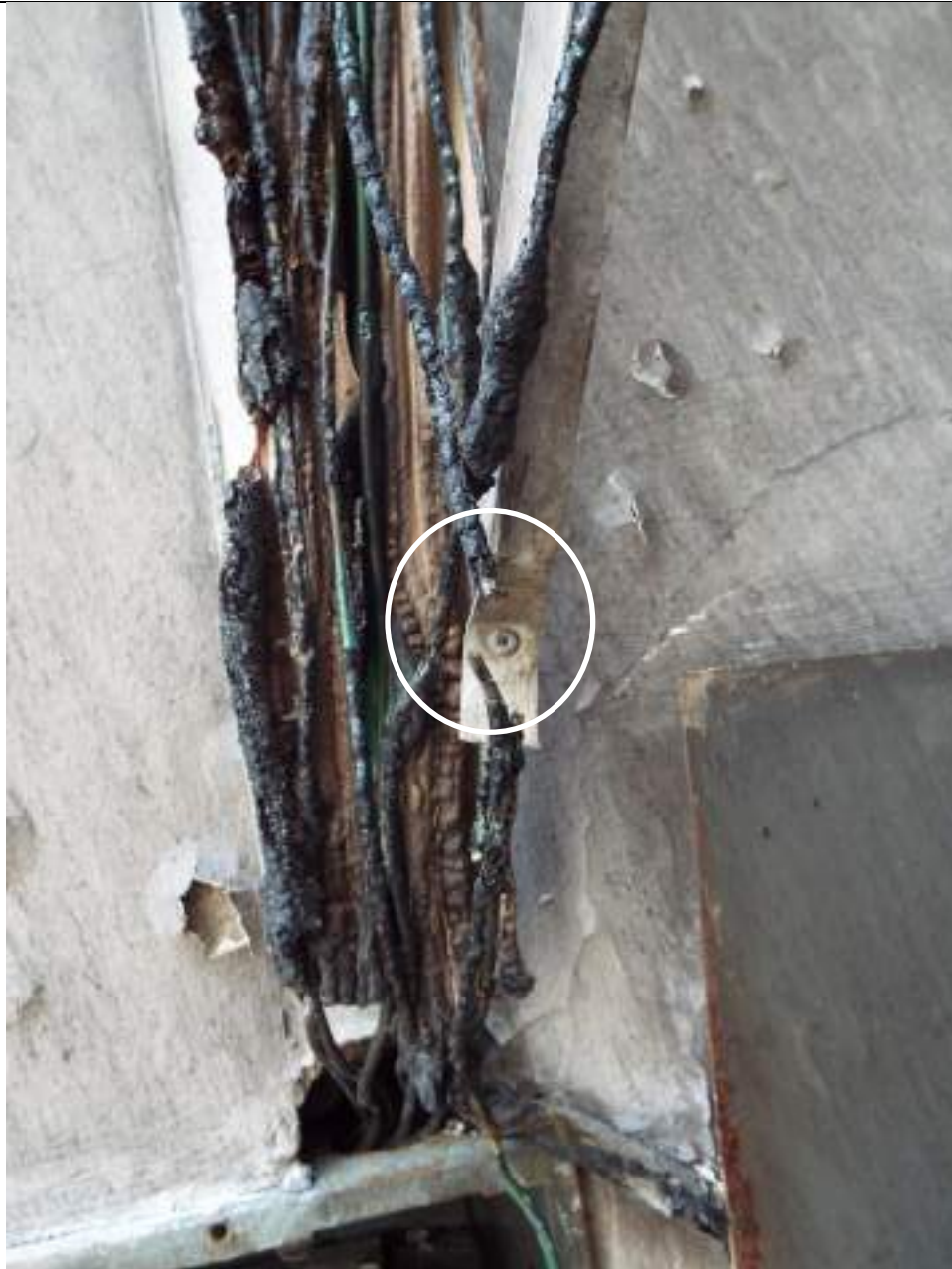
Ilustración 117 - Corte del conductor (cable) que se encontraba aprisionado - EDOC 77 - 25/09/2020
