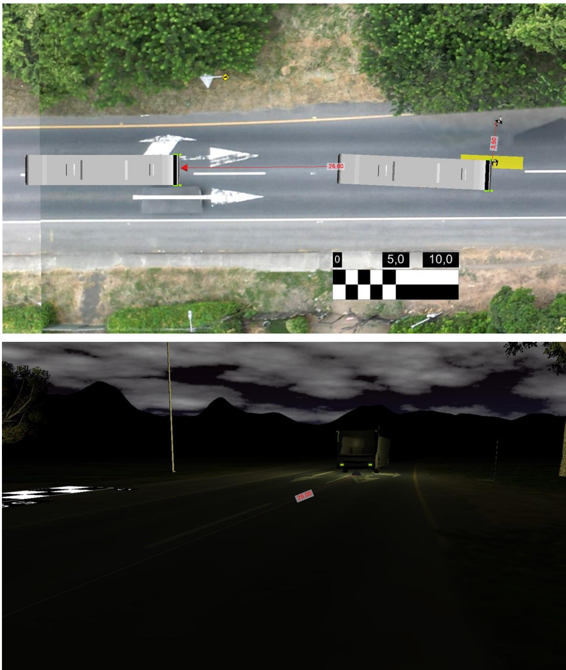
Imagen No. 33: En estas imágenes, vista en planta y 3D se aprecia la ubicación de los involucrados 2 segundos antes del impacto y la posible visibilidad del peatón. Elaboración a escala en el software Trimble Forensics Reveal.
