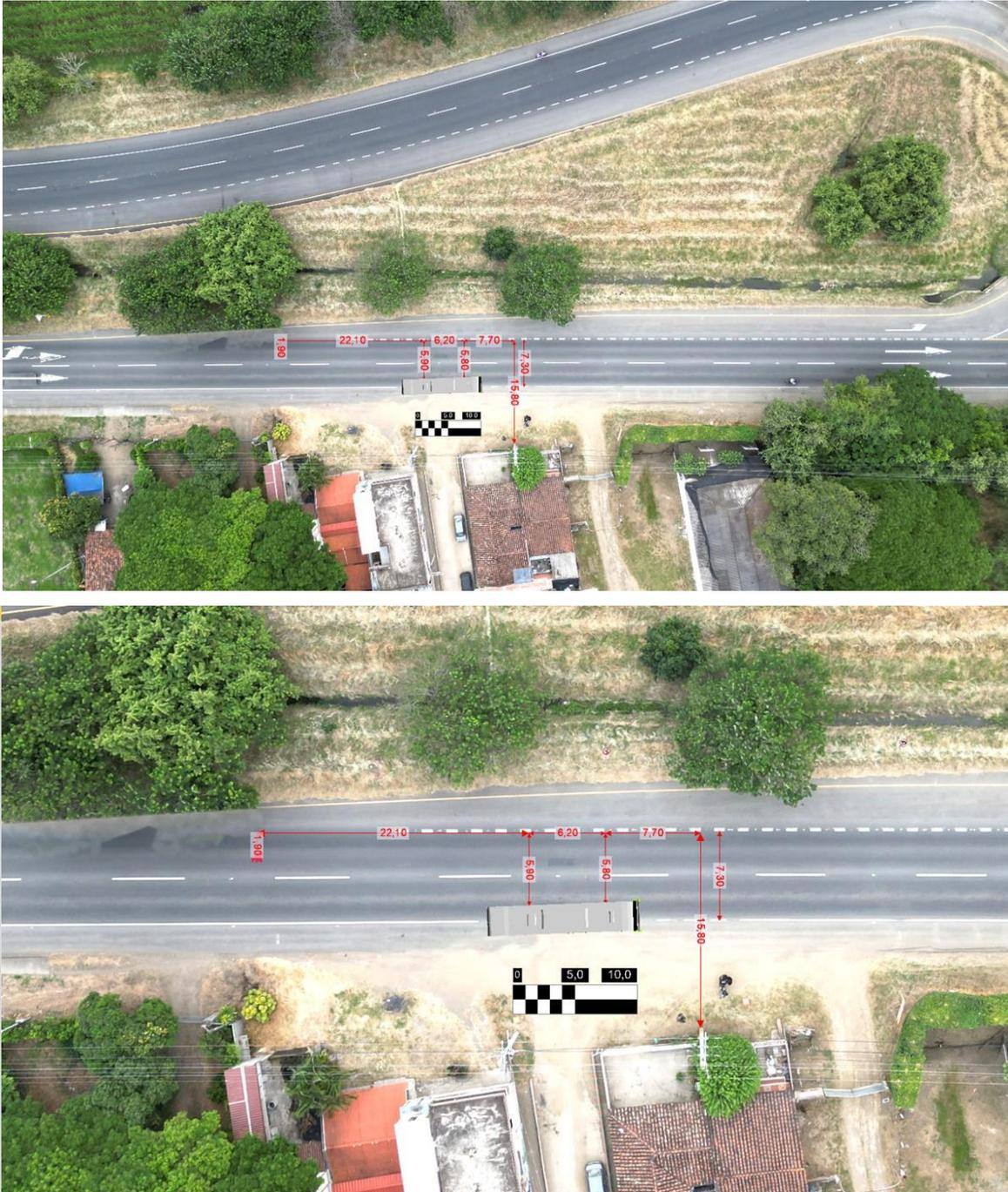
**Imagen No. 15:** En estas imágenes, vista en planta se observan las evidencias diagramadas en el croquis de la autoridad. Elaboración a escala en el software Trimble Forensics Reveal.
