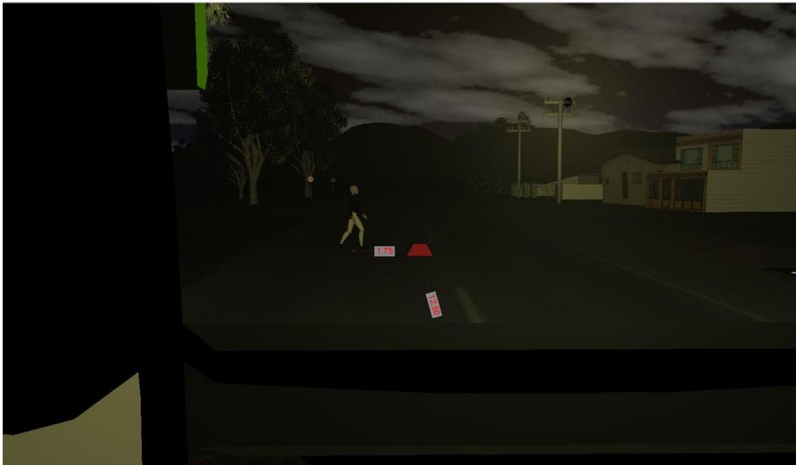
**Imagen No. 34:** En estas imágenes, vista en planta y 3D se aprecia la ubicación de los involucrados 1 segundos antes del impacto y la posible visibilidad del conductor del bus. Elaboración a escala en el software Trimble Forensics Reveal.
