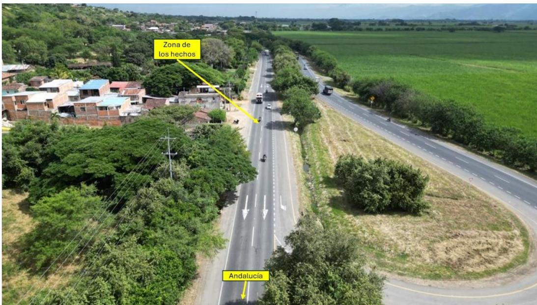
**Fotografía No. 3 Panorámica:** En esta fotografía tomada por el equipo de IRS Vial en sentido Cali – Andalucía y viceversa km 57 + 700 y 800 m, se aprecian las características generales de la vía, en la cual se encuentra demarcación horizontal de línea blanca segmentada, líneas de borde y flechas indicadoras de sentido, con señalización vertical SR-30 (Velocidad máxima 70 km/h); en este sentido se desplazaba el vehículo No. 1 (Bus).
