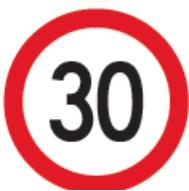
**SEÑAL SR30 – 30** Esta señal se utiliza para indicar la velocidad máxima a la que pueden circular los vehículos a partir del lugar donde esté instalada. Debe ser repetida con un espaciado entre 2 y 5 km de no haber un cambio de velocidad. Además, se debe colocar en los primeros 300 metros después de cada incorporación de otra vía.
