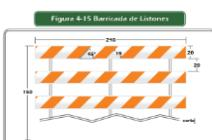
**SEÑAL TEMPORAL BARRICADA DE LISTONES:** Las barricadas se utilizan para hacer cierres de carriles o calzadas, para cerrar áreas de trabajo y para delinear angostamientos. Cuando se emplean para cerrar vías o carriles se colocan de forma perpendicular al eje de la vía
