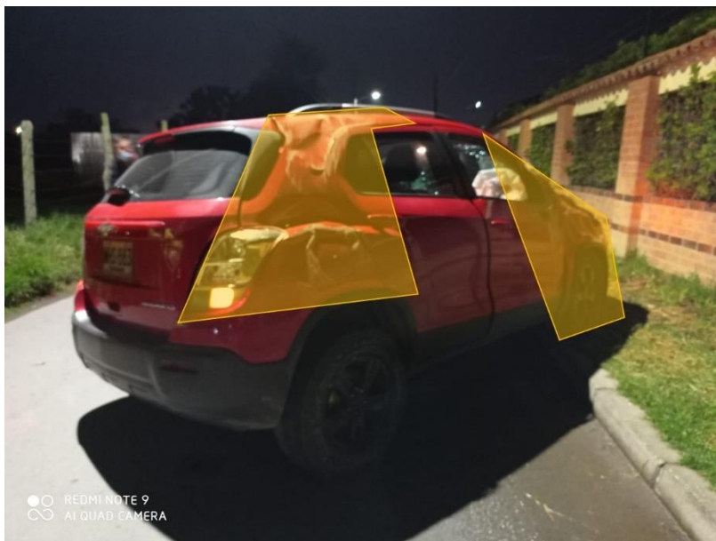
FOTOGRAFIA No.10 PLANO MEDIO : En esta fotografía se aprecia el estado final de la Camioneta que presenta daños en el tercio anterior y posterior derecho.
