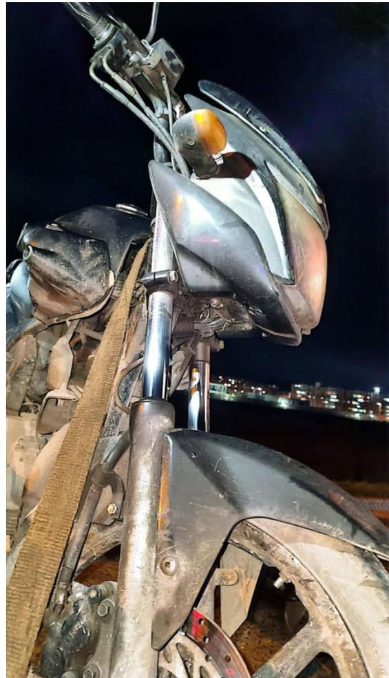
**Fotografías No. 12 Primer plano:** En estas fotografías, tomadas el día de los hechos, se observa el lado derecho sección frontal y parte trasera de la MOTOCICLETA, NO se evidencian daños por impacto contra otro vehículo.
