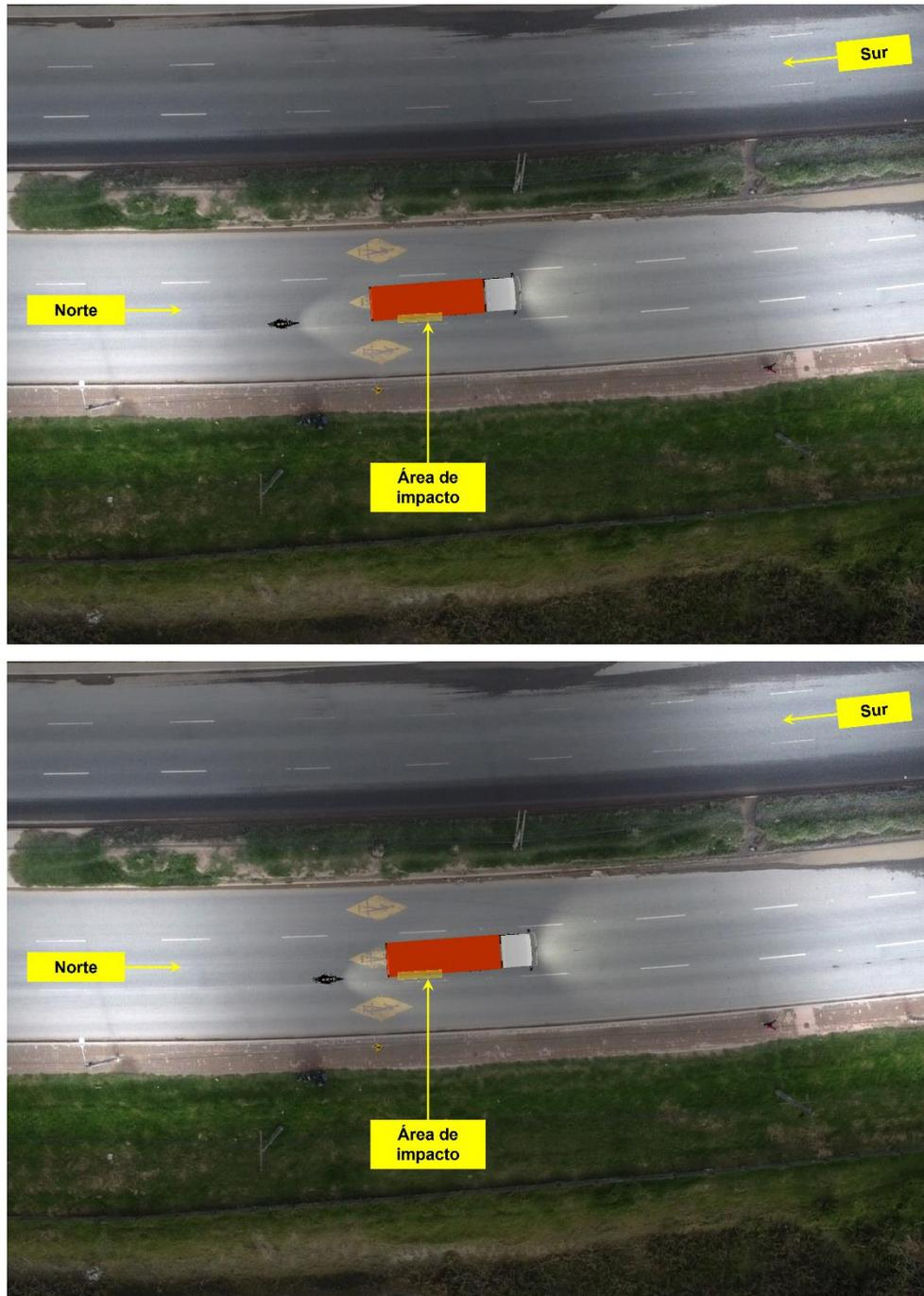
**Imagen No. 18:** En estas imágenes se observa en vista en planta el área de impacto y la posición de los vehículos 1,5 (imagen superior) y 1,0 (imagen inferior) segundos antes de la interacción. Estas posiciones se encontraron asumiendo velocidad constante.
