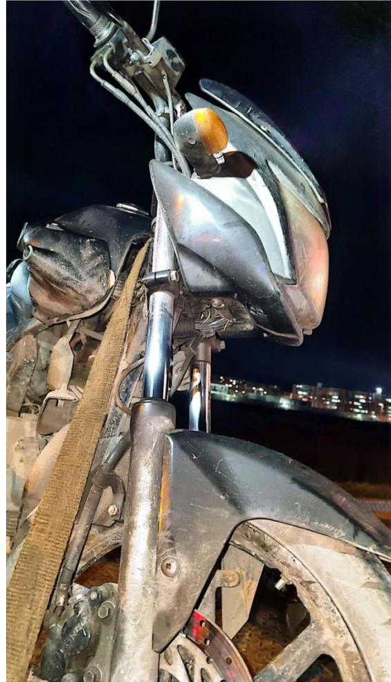
**Fotografías No. 8 y 9 Primer plano:** En estas fotografías, tomadas el día de los hechos, se observa el lado derecho sección frontal y parte trasera de la MOTOCICLETA, no se evidencian daños por impacto contra otro vehículo.
