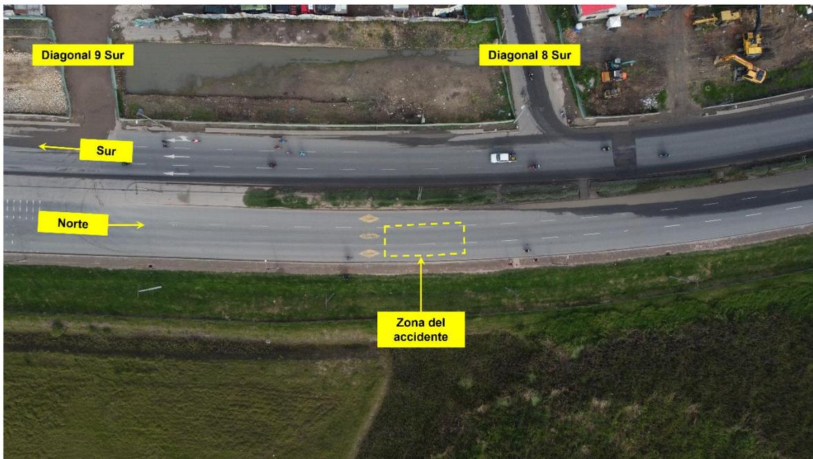
**Fotografía No. 1 Vista en planta:** En esta fotografía, tomada con DRONE, se observan las características generales de la autopista sur a la altura de la diagonal 8 sur, se evidencia que la calzada involucrada tiene demarcación de líneas de borde de pavimento, de carril y pictogramas de la señal SP-46A proximidad de cruce peatonal.
