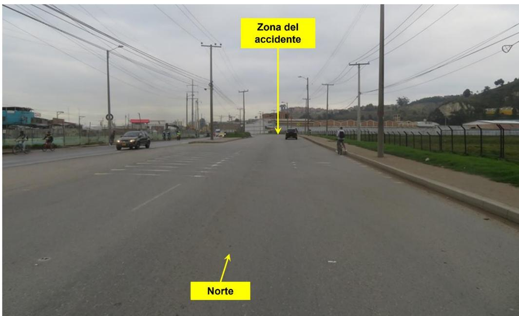
**Fotografías No. 4 y 5 Panorámica:** En estas fotografías, tomadas en sentido en sentido sur a norte sobre la autopista sur al sur de la diagonal 8 sur, se evidencia que la calzada oriental tiene bandas sonoras y demarcación de líneas de borde de pavimento y de carril, además tiene una señal de prohibido girar a la izquierda (SR-06). En este sentido de circulación se desplazaban los vehículos.
