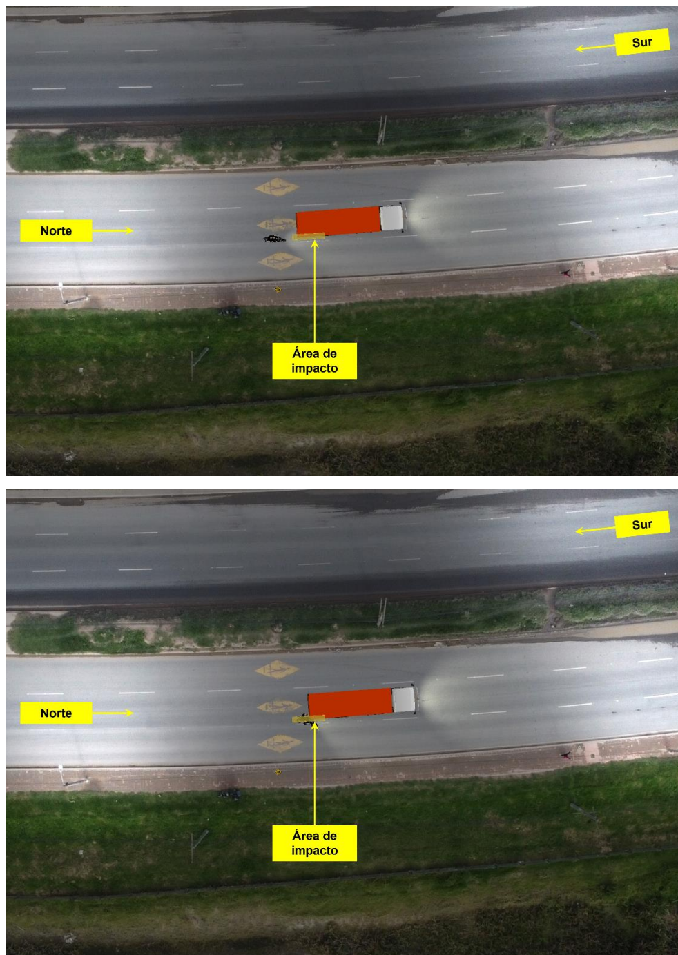
Imagen No. 19: En estas imágenes se observa en vista en planta el área de impacto y la posición de los vehículos 0,5 segundos (imagen superior) antes y al momento de la interacción (imagen inferior). La posición antes del impacto se encontró asumiendo velocidad constante.
