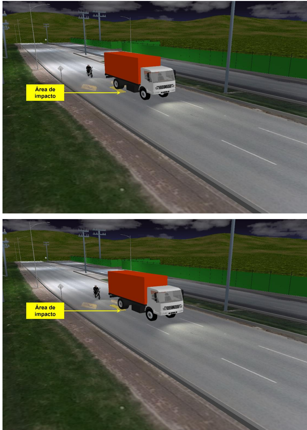
Imagen No. 22: En estas imágenes se observa en 3D el área de impacto y la posición de los vehículos 1,5 (imagen superior) y 1,0 (imagen inferior) segundos antes de la interacción. Estas posiciones se encontraron asumiendo velocidad constante.
