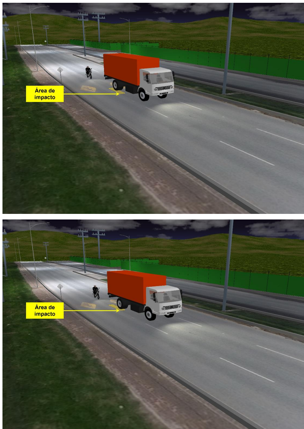
Imagen No. 21: En estas imágenes se observa en 3D el área de impacto y la posición de los vehículos 1,5 (imagen superior) y 1,0 (imagen inferior) segundos antes de la interacción. Estas posiciones se encontraron asumiendo velocidad constante.
