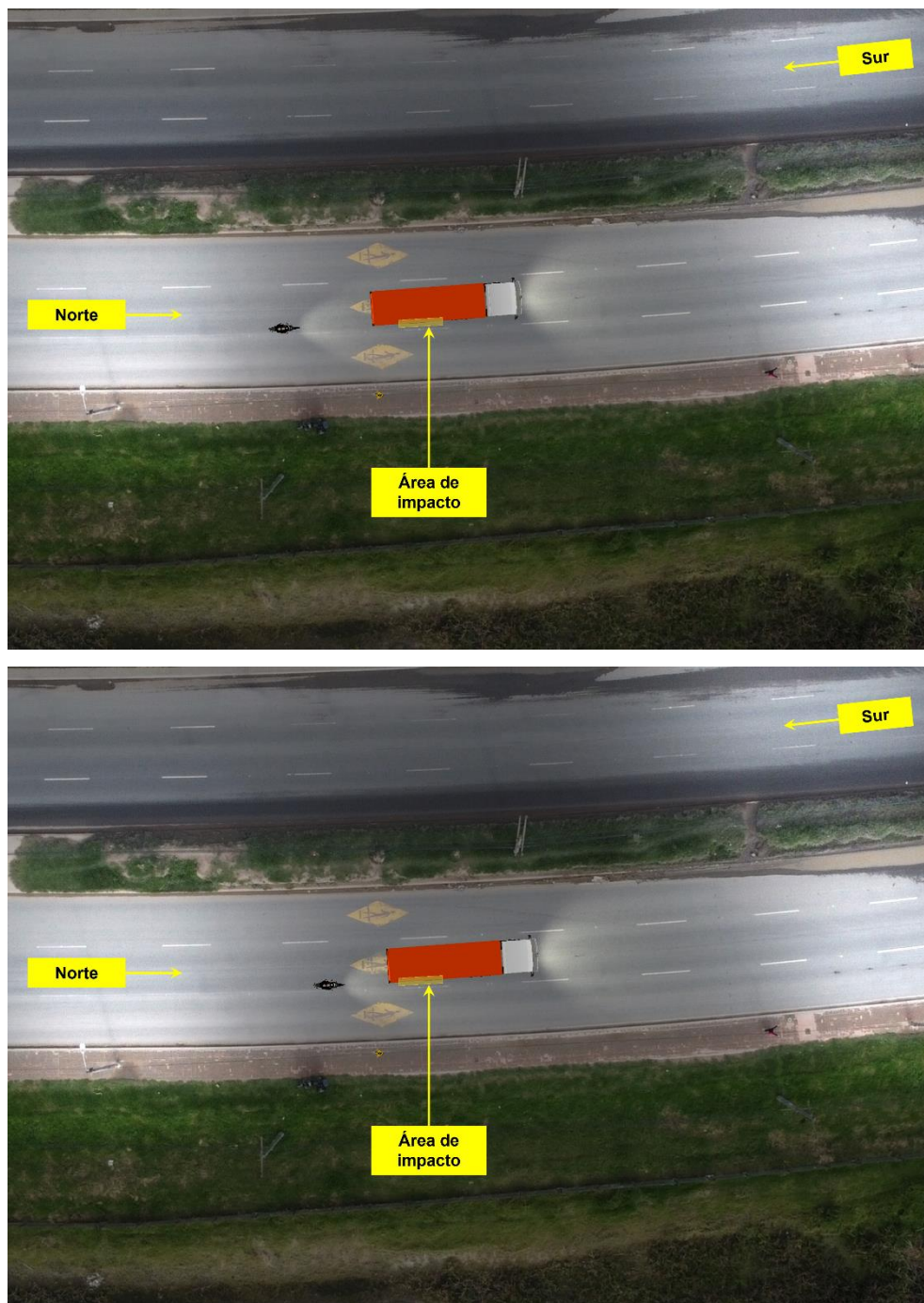
Imagen No. 19: En estas imágenes se observa en vista en planta el área de impacto y la posición de los vehículos 1,5 (imagen superior) y 1,0 (imagen inferior) segundos antes de la interacción. Estas posiciones se encontraron asumiendo velocidad constante.
