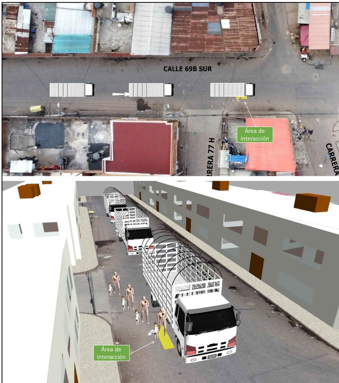
Imagen No.20: Imagen compuesta de vista en planta y en 3D de la secuencia establecida para el evento en donde se plasma la ruta de circulación del camión y la orientación probable del peatón previo al contacto, nótese su posición relativa al momento de la interacción.
