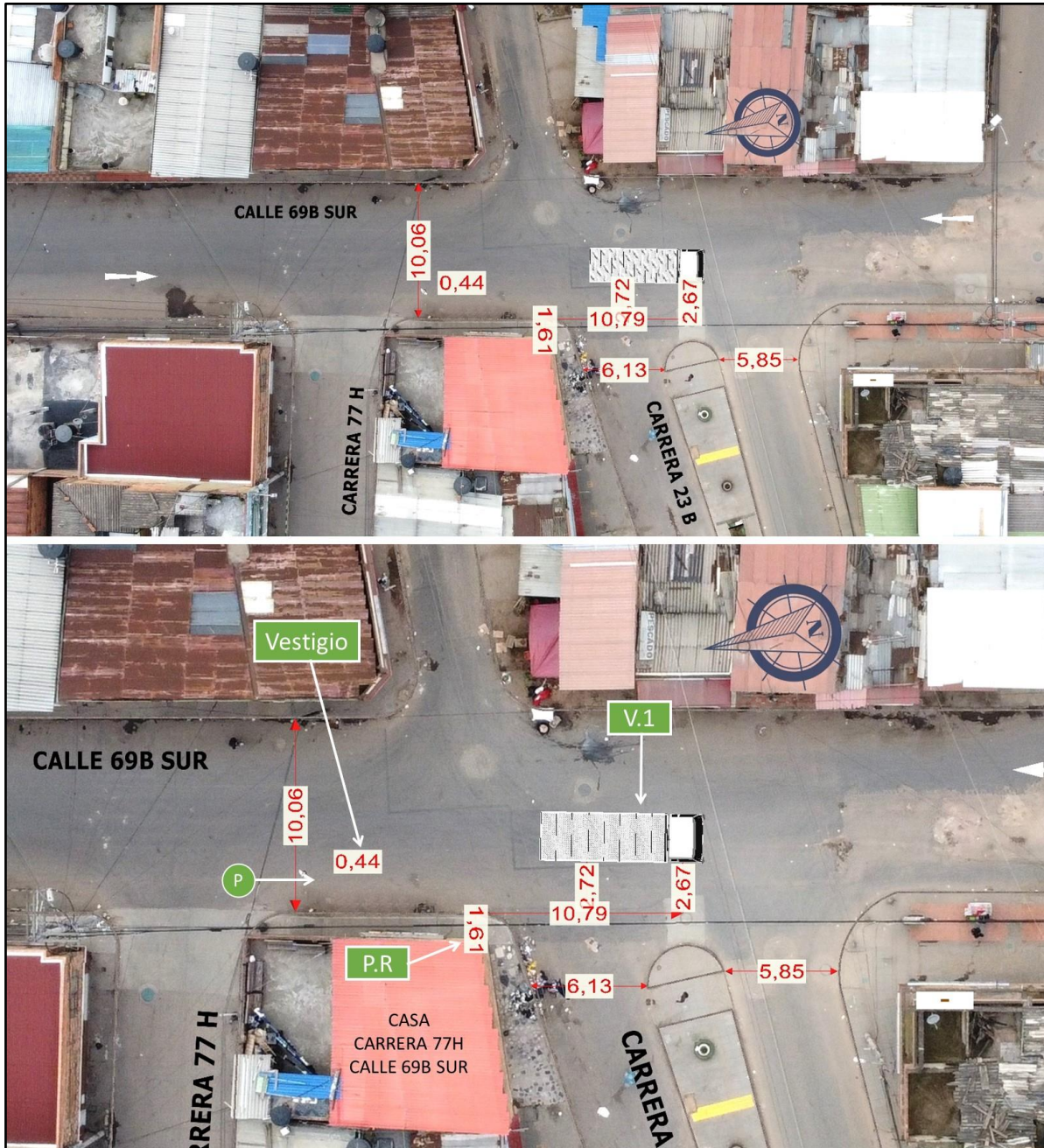
Imagen No.10: Imagen compuesta de vista en planta de la elaboración a escala en el software Trimble Forensic Reveal, del Bosquejo elaborado para el evento, se identifica que las cotas No.1 y No.2 en el eje de las "X" no son compatibles con relación a las dimensiones del vehículo tomada desde sus vértices, nótese un vestigio diagramado y sin acotar en el bosquejo.
