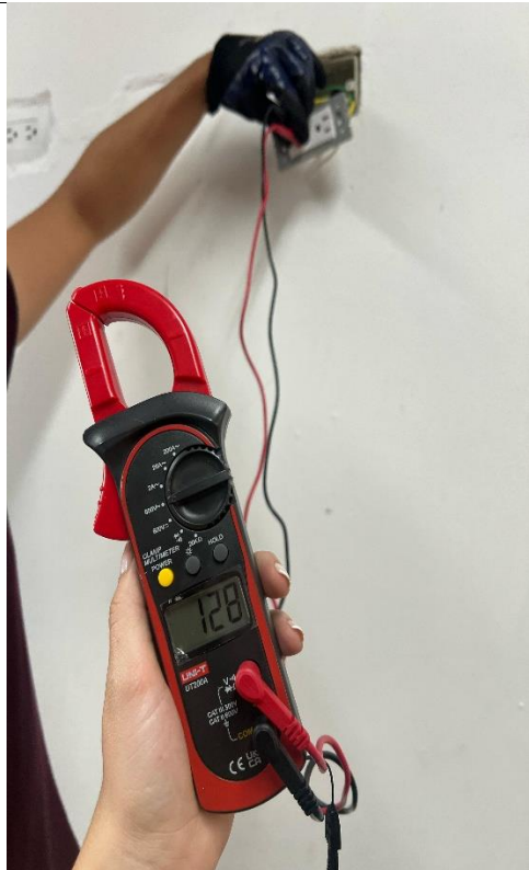
Ilustración 8: Medición de tomas dobles, identificando su conexión a tierra
