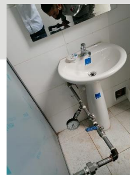
Imagen 3-4-5-6 Pruebas de presión en baños con resultados favorables piso 2.
