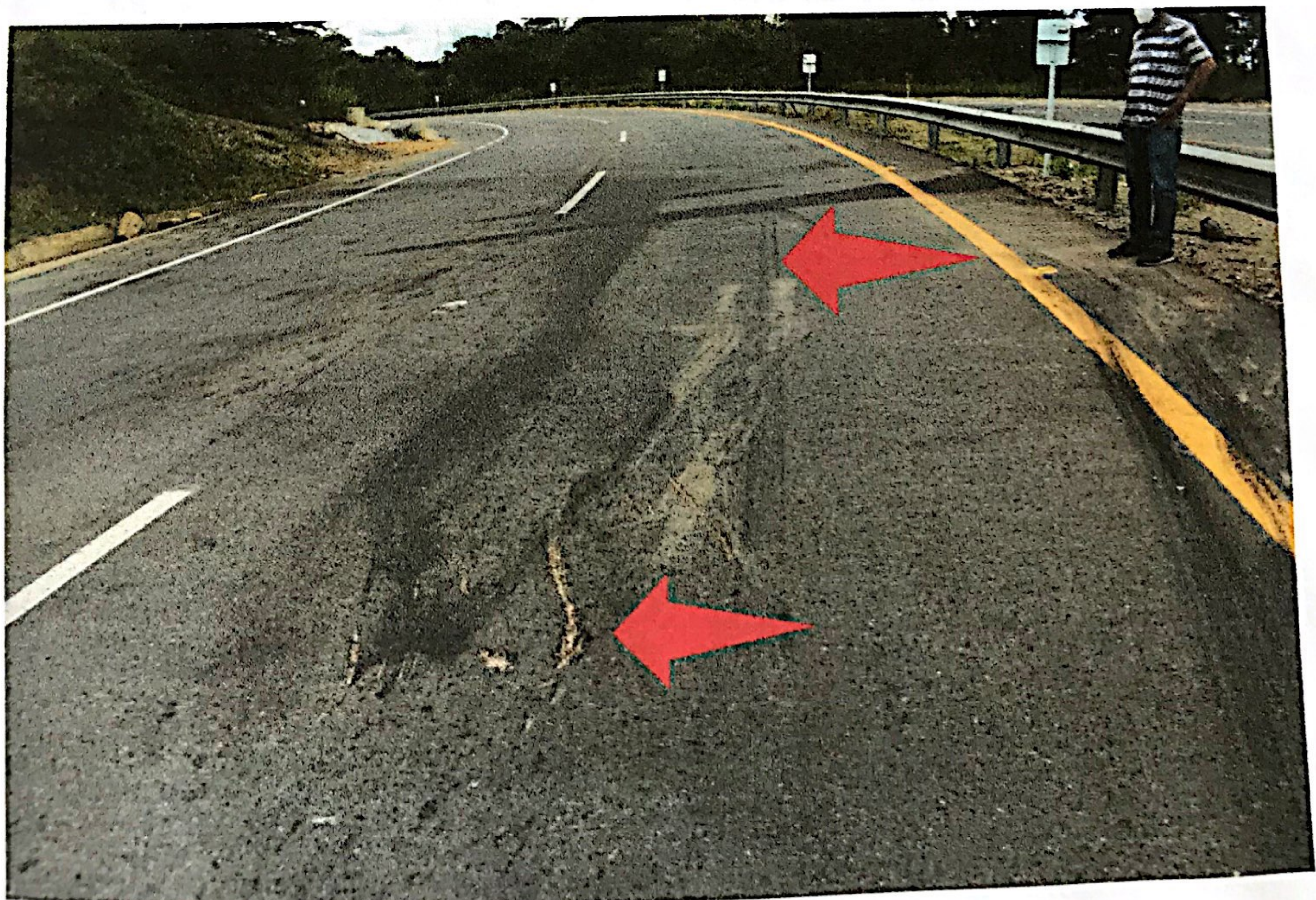
Fotografia 16. Huella de arrastre posible lugar del impacto entre los dos automotores y huella de frenado al parecer del automovil..
