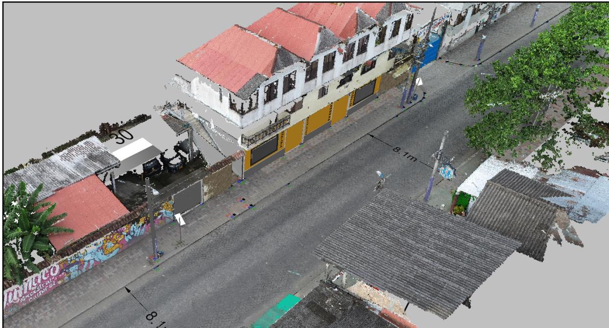
Imagen 4. Reconstrucción 3D realizada mediante el procesamiento de imágenes usando software Metashape Agisfot, WebODEME, elementos que complementan las medidas registradas con la estación total. Reconstrucción del lugar de los hechos realizada en software Faro Zone 3D.
