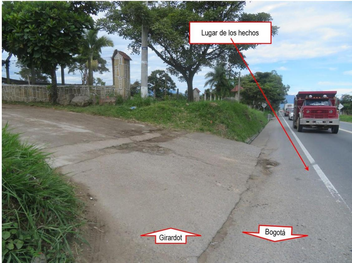
**Fotografía No.5 Plano General:** fotografía tomada en sentido Bogotá Girardot km 60 + 200 m; donde se observan las características generales del tramo de vía, recta, plano, estado bueno, asfalto, doble sentido, en la cual se encuentra demarcación horizontal línea central segmentada y doble continua, líneas de borde blanca y amarillo.
