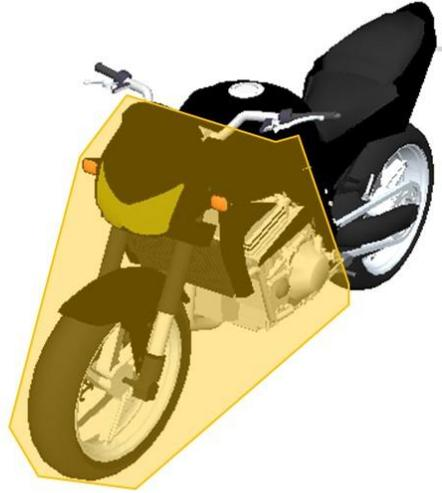
**Imagen No.7:** En esta imagen basada en los reportes se resalta la zona de daños y evidencias en el rodante.
