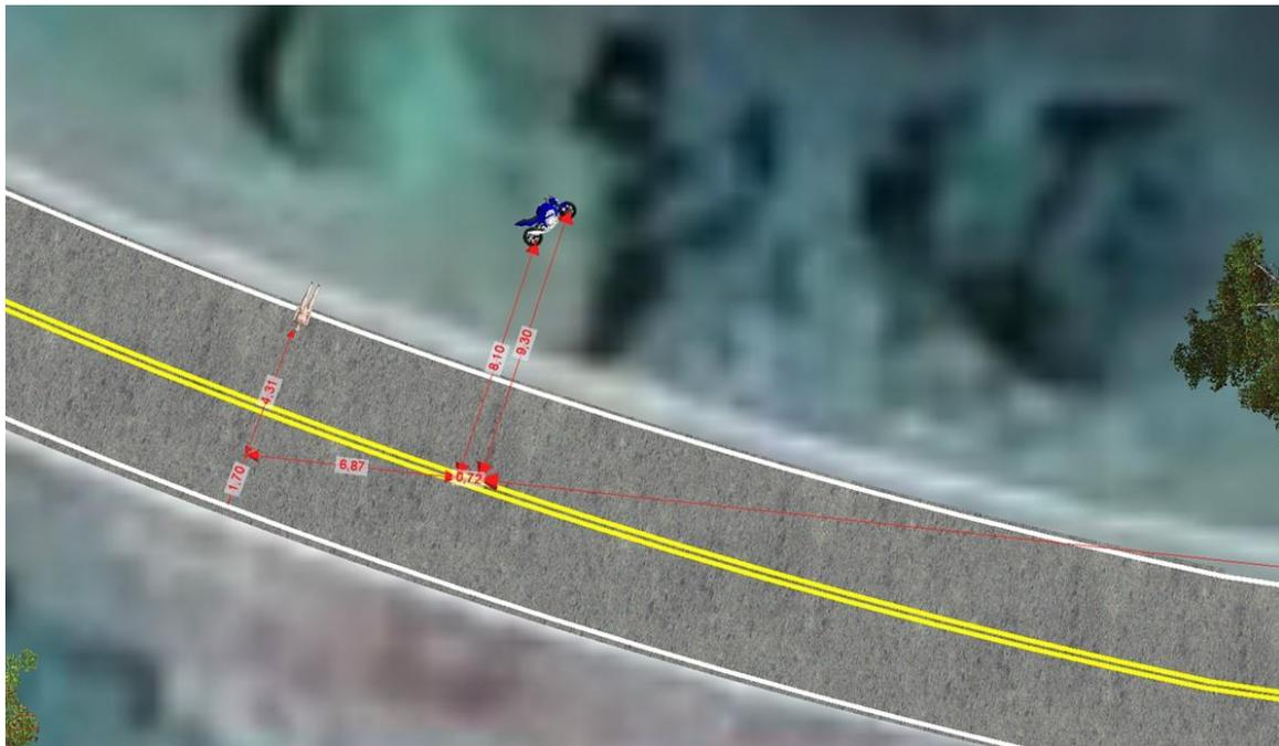
**Imagen No. 14:** En estas imágenes, vista en planta se observan las evidencias diagramadas en el croquis de la autoridad. Elaboración a escala en el software Trimble Forensics Reveal.
