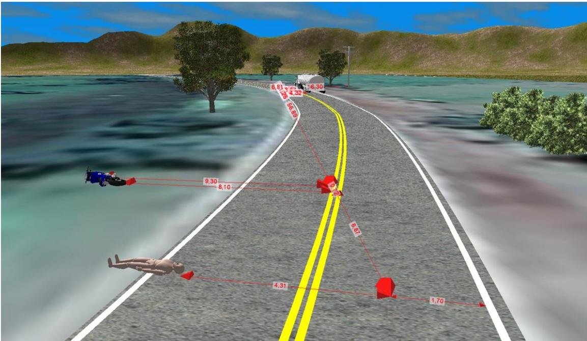
**Imagen No. 16:** En estas imágenes en 3D se observan las evidencias diagramadas en el croquis de la autoridad. Elaboración a escala en el software Trimble Forensics Reveal.
