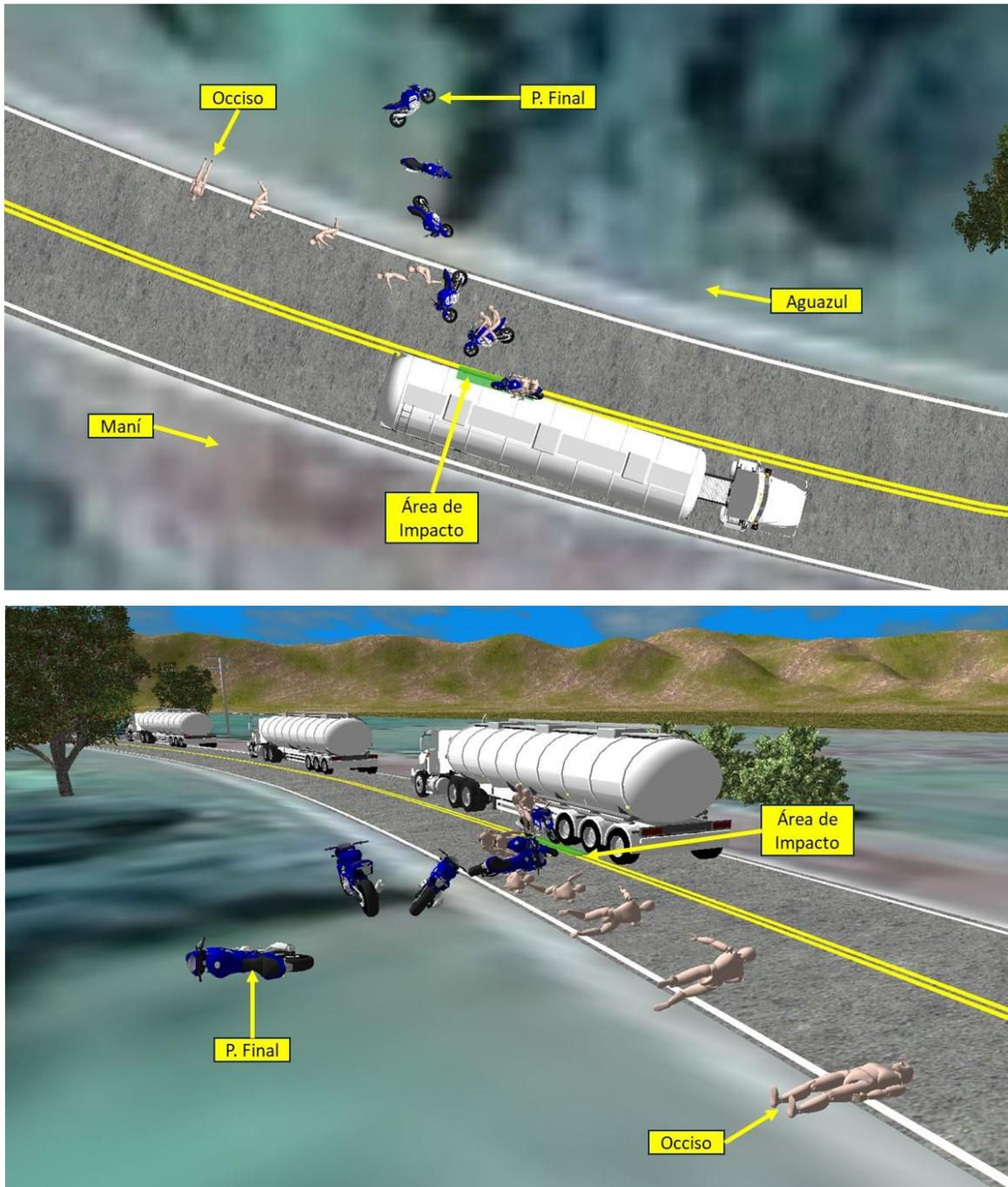
**Imagen No. 23:** En estas imágenes, vista en planta y 3D se aprecia la secuencia del siniestro al momento y posterior al impacto, nótese el movimiento hasta sus posiciones finales. Elaboración a escala en el software Trimble Forensics Reveal.
