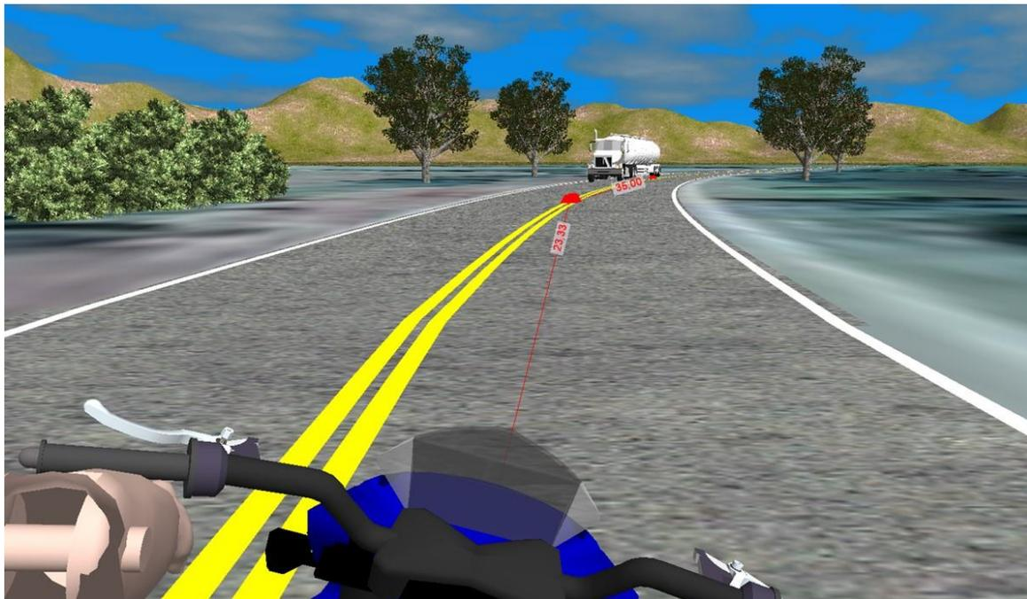
**Imagen No. 35:** En estas imágenes, vista en planta y en 3D se aprecia la ubicación de los vehículos 2 s antes del impacto si sus velocidades son constantes y la posible visibilidad del conductor de la motocicleta. Elaboración a escala en el software Trimble Forensics Reveal.
