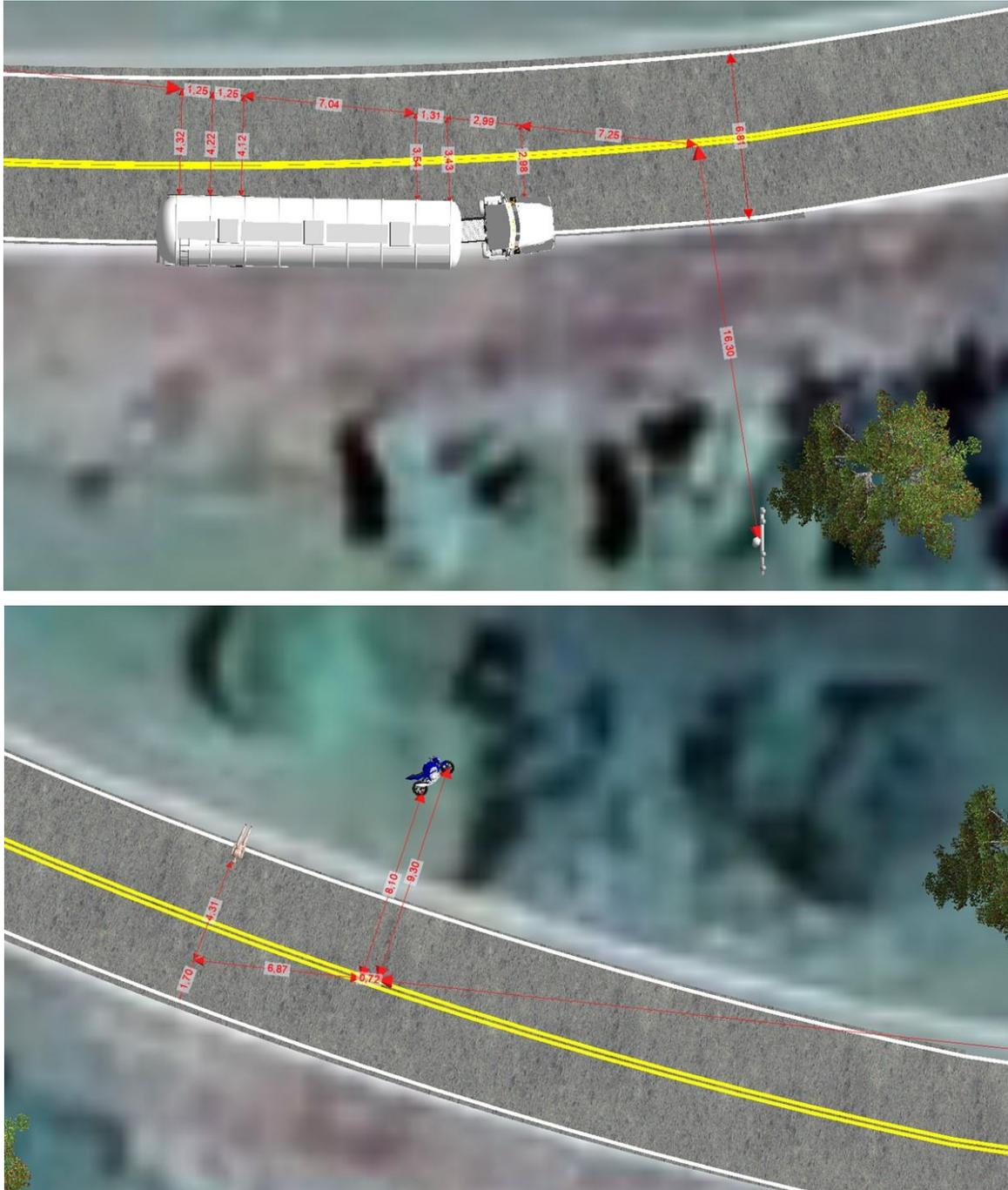
**Imagen No. 14:** En estas imágenes, vista en planta se observan las evidencias diagramadas en el croquis de la autoridad. Elaboración a escala en el software Trimble Forensics Reveal.
