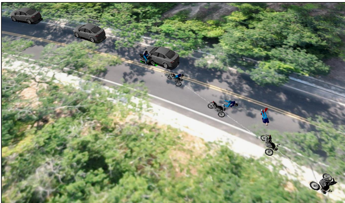
Imagen No. 40: En estas imágenes se aprecia la secuencia del accidente después de la colisión entre los vehículos, y sus posiciones finales.
