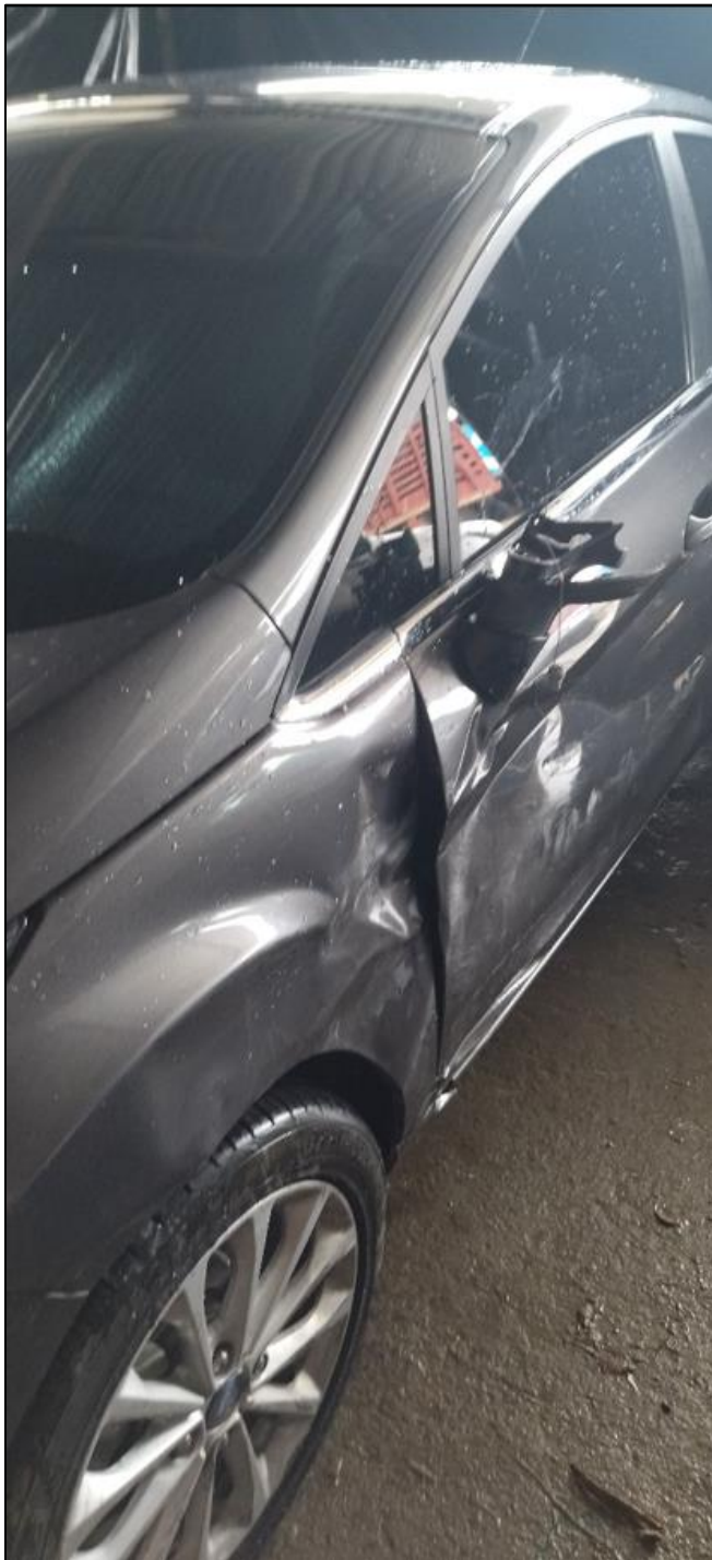
Fotografía No. 10: En esta fotografía se aprecia la deformación entre el guardafangos y la puerta anterior del automóvil.
