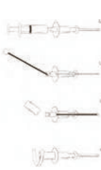
Figura 3 Resumen del manejo de dispositivo manual: A y B. Desenrosque la porción posterior, C. Retire el estilete interno, D. Conecte una jeringa para verificación.
