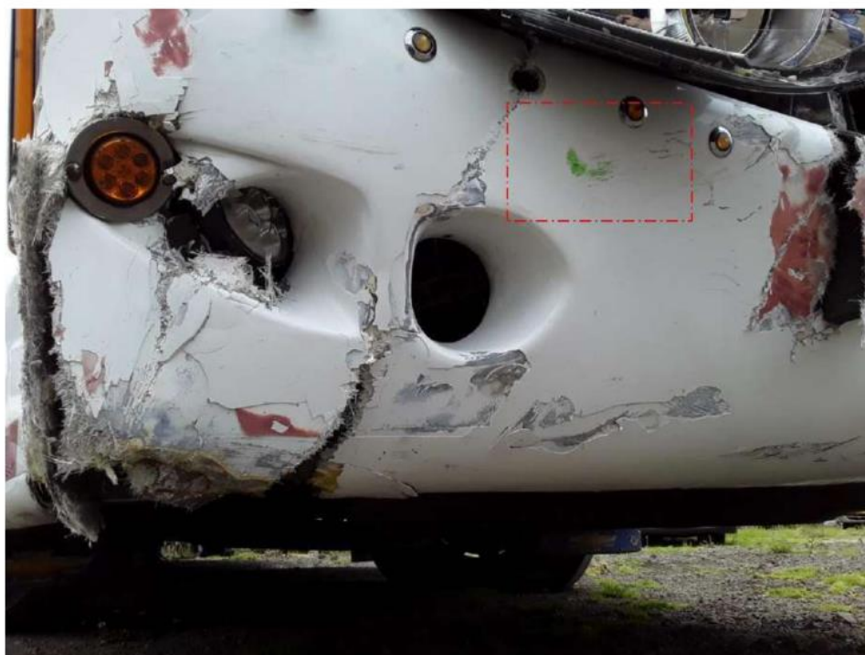
Fotografía No. 5: Se observa un acercamiento a los daños presentes en el automotor en la zona anterior, donde se observa el desalojo y rotura parcial del paragolpes anterior, así mismo se referencia traspaso de pintura ubicada en la zona frontal tercio-inferior.
