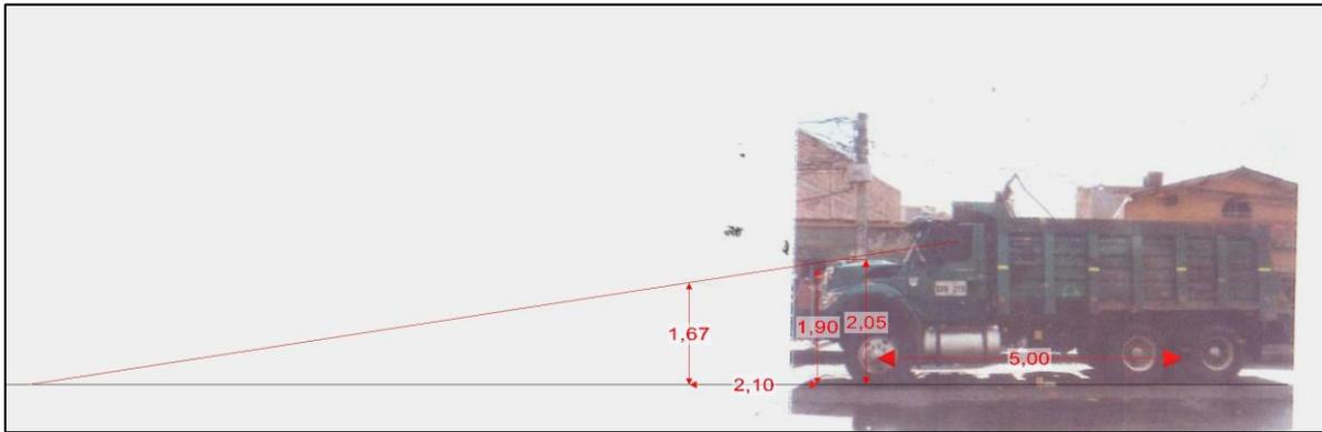
**Imagen No. 34:** Se representa a escala la relación de alcance visual de la posición de manejo del conductor de la volqueta vs ubicación desde donde llegaría a ser identificable aproximadamente la presencia de una persona de 1,61 m de altura.
