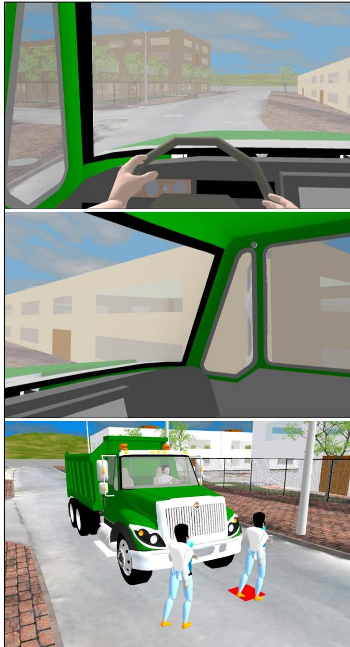
**Imagen No. 35:** En esta imagen en perspectiva 3D se indica la más probable posición relativa del vehículo y el peatón al momento de la interacción, se muestra además la visibilidad del conductor del vehículo donde se observa que no puede percibir al peatón antes de iniciar la marcha.
