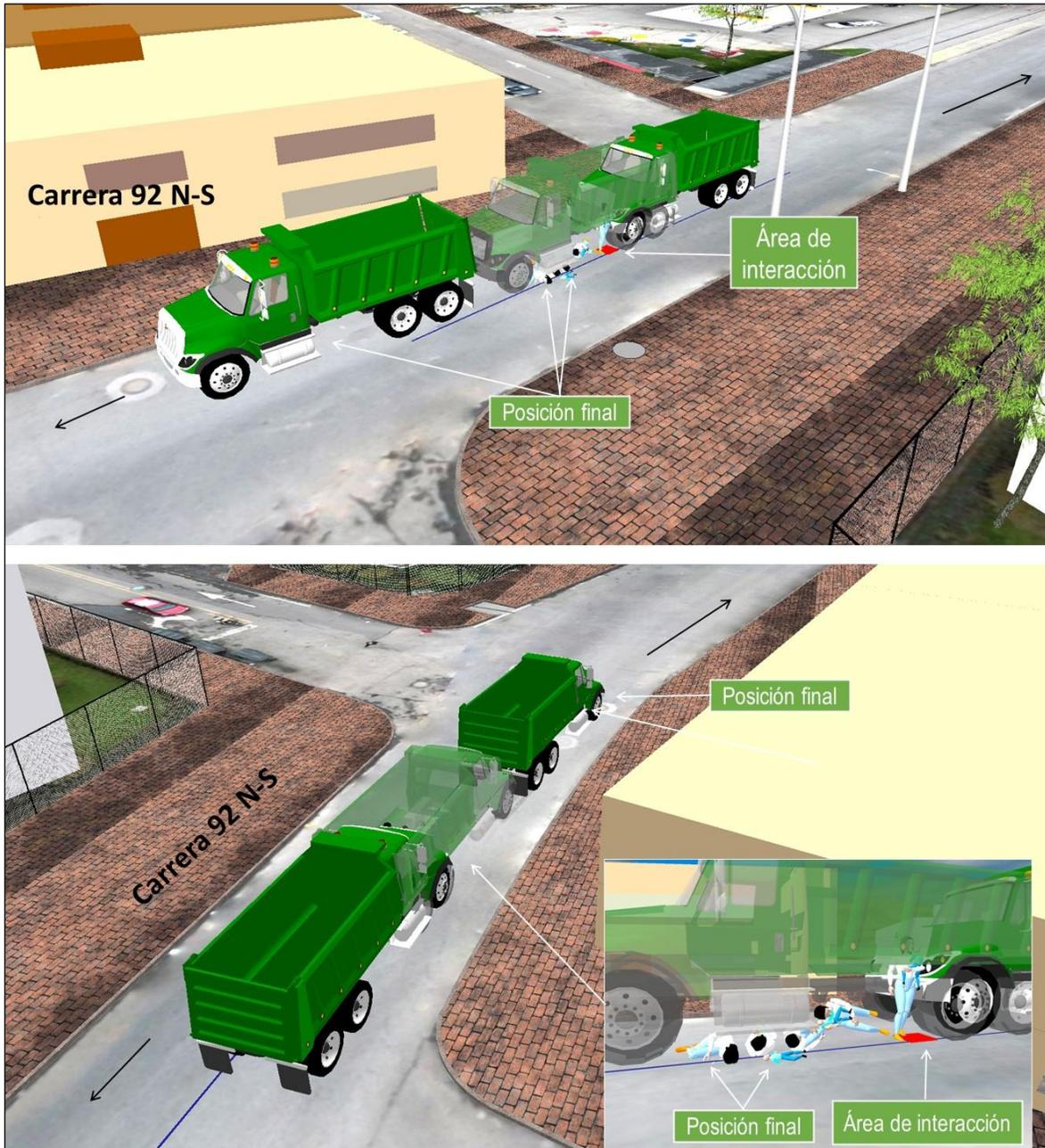
**Imagen No. 30:** En estas imágenes vistas en 3D se observa la secuencia al momento y después de la interacción hasta las posiciones finales, nótese la posición relativa y el área de interacción de color rojo sobre la vía. Elaborada en el software Trimble Forensic Reveal.
