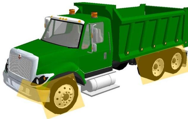
**Imagen No. 9:** En esta imagen basada en los reportes se resalta la zona de daños y evidencias en el rodante. Elaboración en el software Trimble Forensic Reveal.
