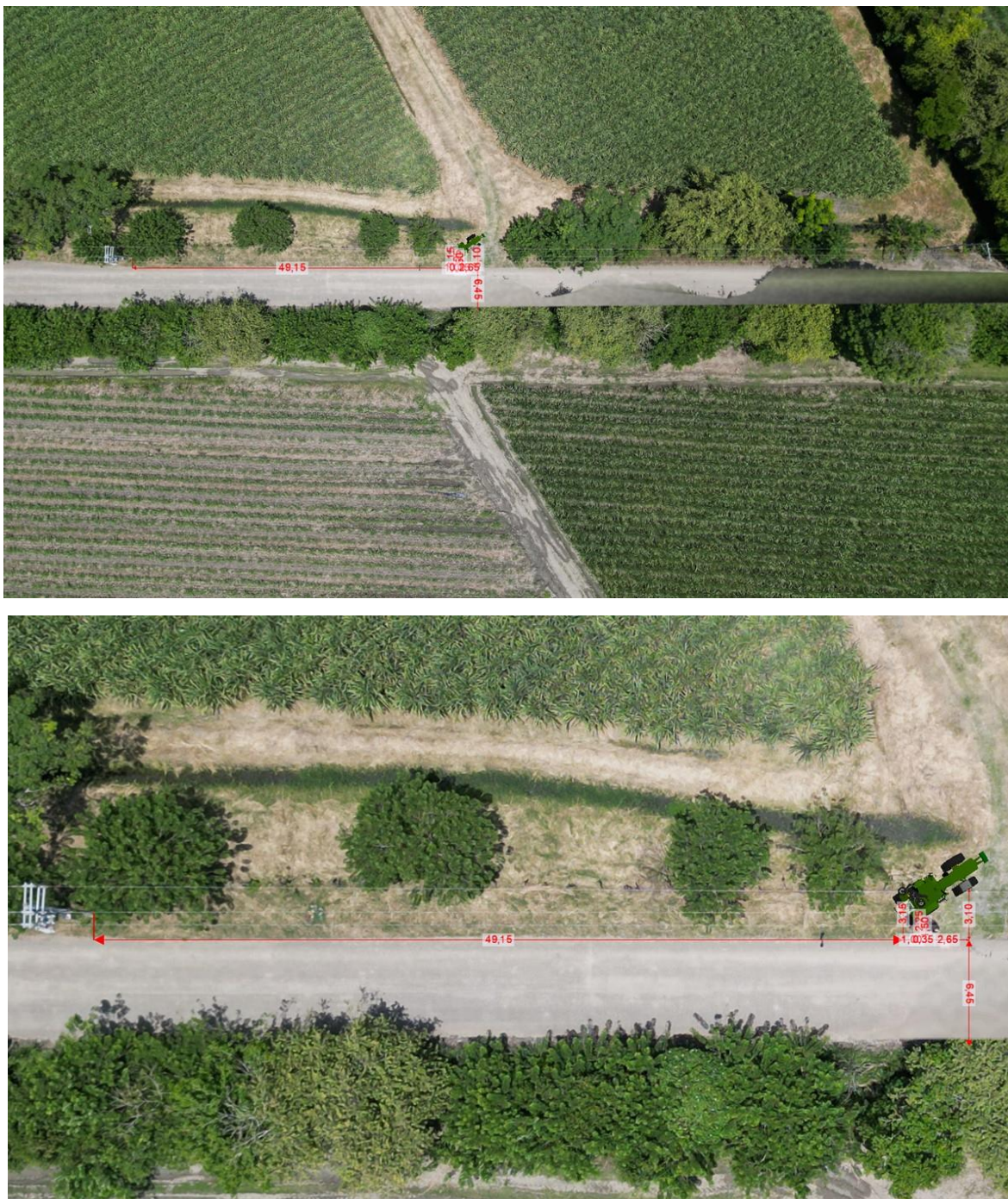
Imagen No. 12: En estas imágenes, vista en planta se observan las evidencias diagramadas en el croquis de la autoridad. Elaboración a escala en el software Trimble Forensics Reveal.
