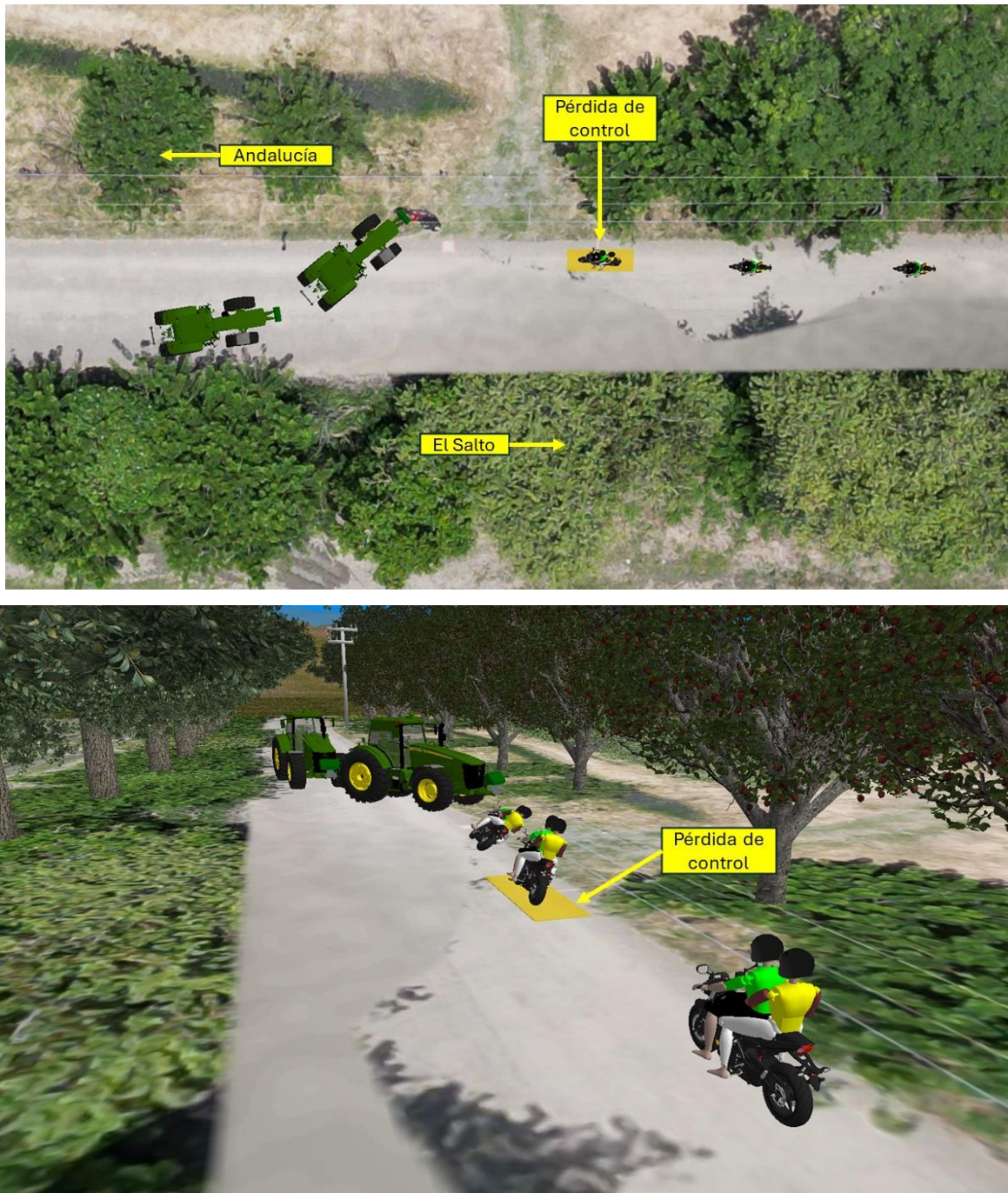
Imagen No. 23: En estas imágenes, vista en planta y 3D se aprecia la secuencia del accidente antes y al momento de la pérdida de control, nótese el sentido de desplazamiento de los vehículos y el área donde se presenta. Elaboración a escala en el software Trimble Forensics Reveal.
