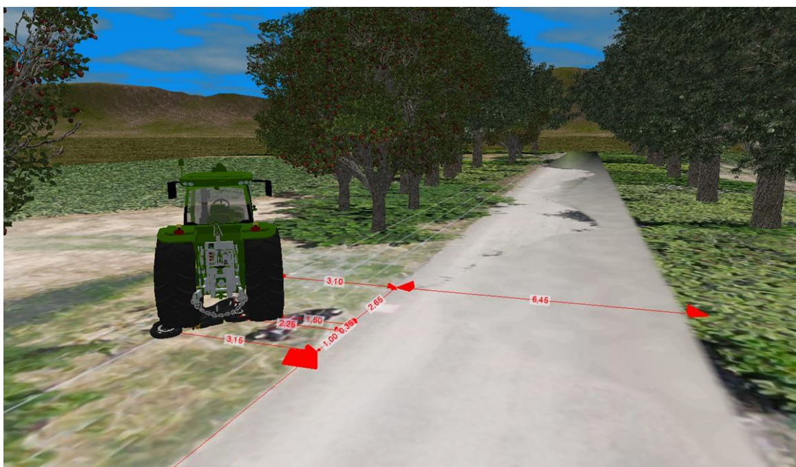
Imagen No. 14: En estas imágenes en 3D se observan las evidencias diagramadas en el croquis de la autoridad. Elaboración a escala en el software Trimble Forensics Reveal.
