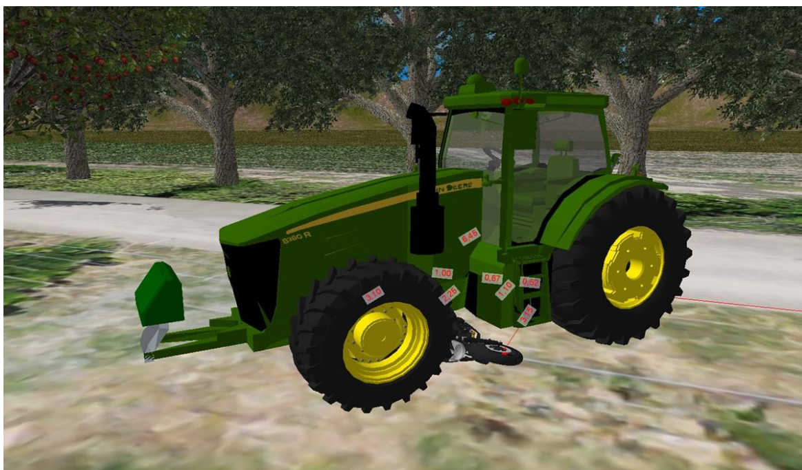
Imagen No. 17: En estas imágenes en 3D se observan las evidencias diagramadas en el croquis de la autoridad y el ajuste con base en el estudio de fotogrametría. Elaboración a escala en el software Trimble Forensics Reveal.
