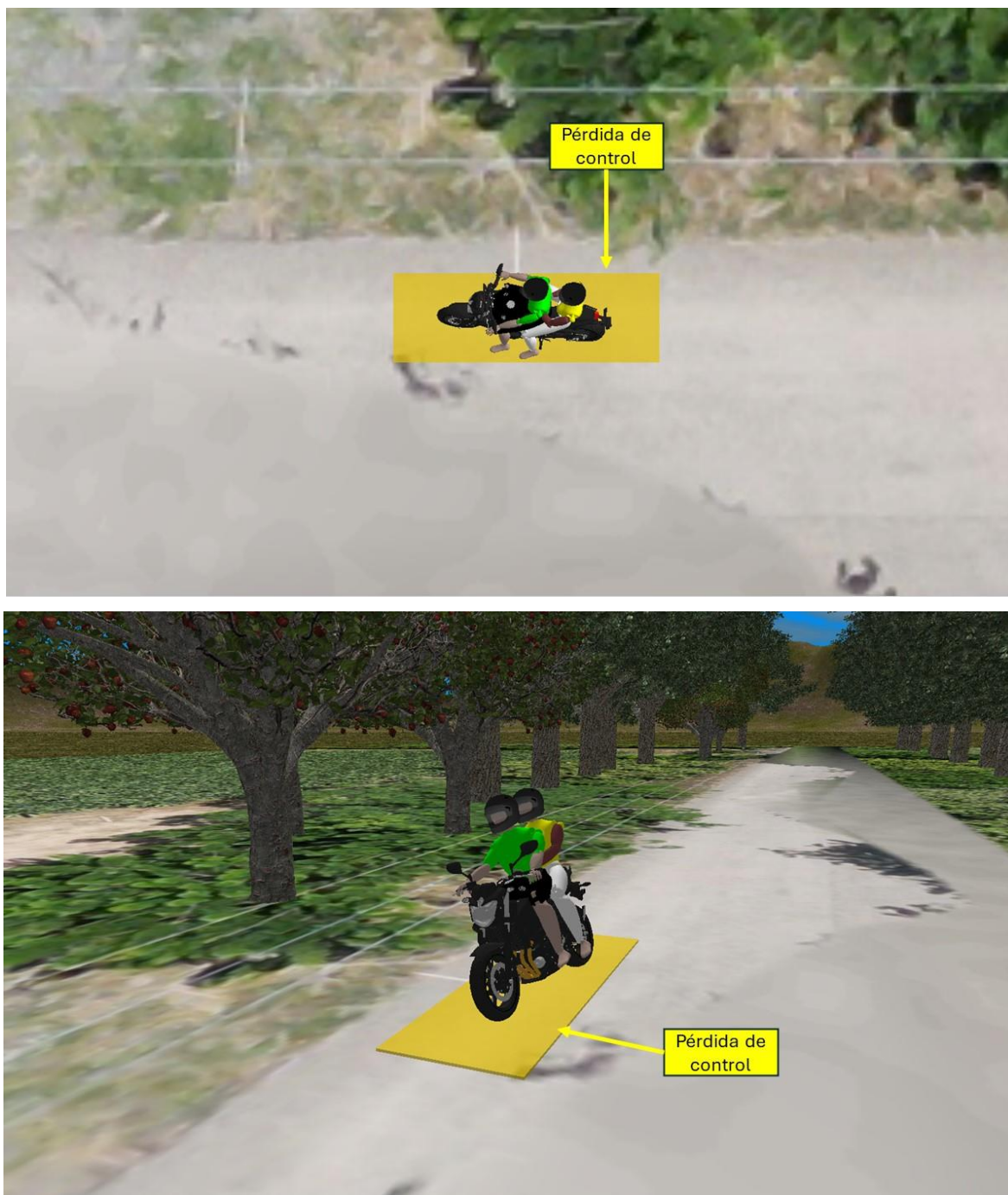
Imagen No. 18: En estas imágenes, vista en planta y en 3D se aprecia la posición relativa al momento de la pérdida de control y el área en la vía donde se presenta. Elaboración a escala en el software Trimble Forensics Reveal
