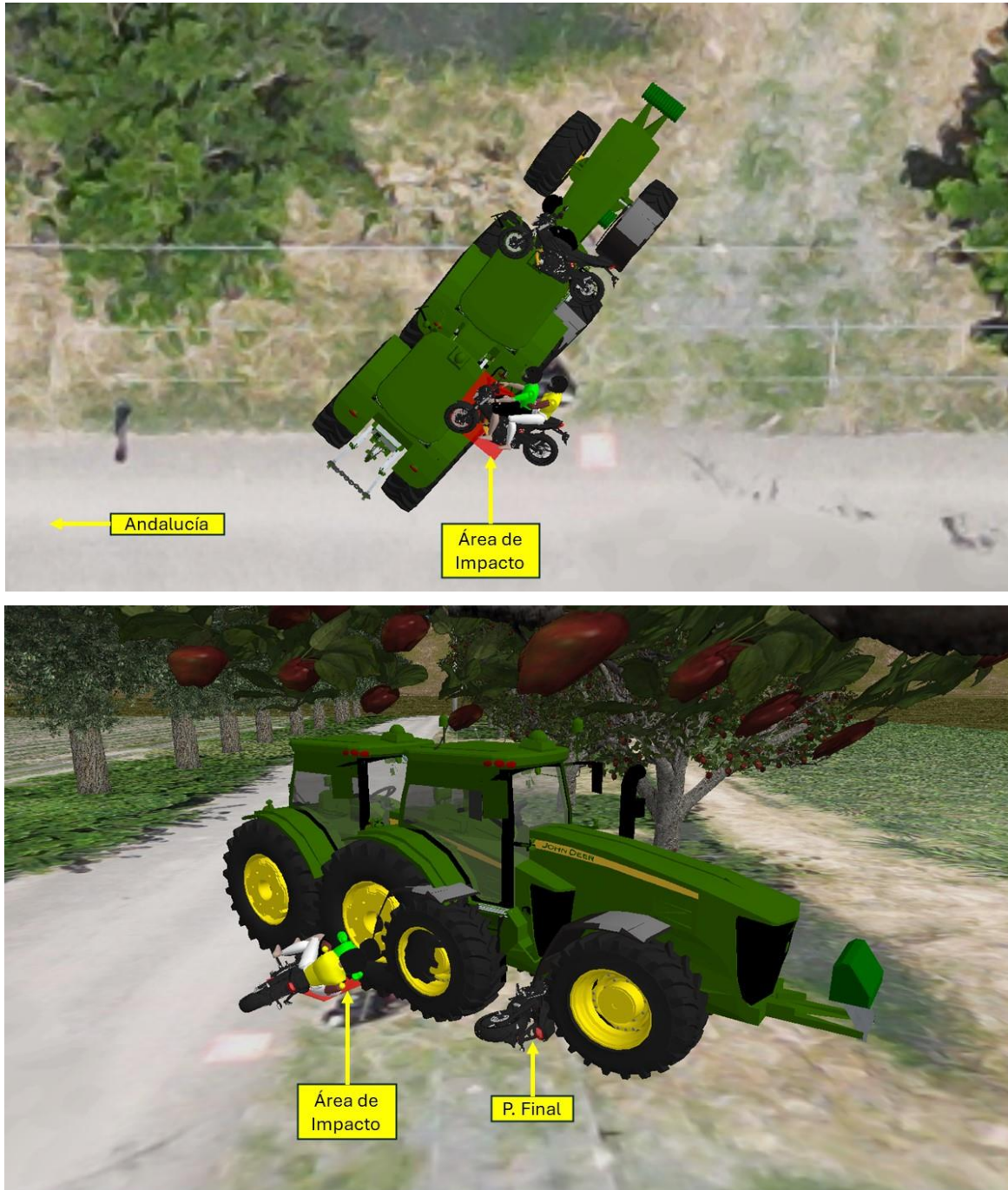
Imagen No. 25: En estas imágenes, vista en planta y 3D se aprecia la secuencia del accidente al momento y posterior al impacto, nótese el movimiento hasta sus posiciones finales. Elaboración a escala en el software Trimble Forensics Reveal.
