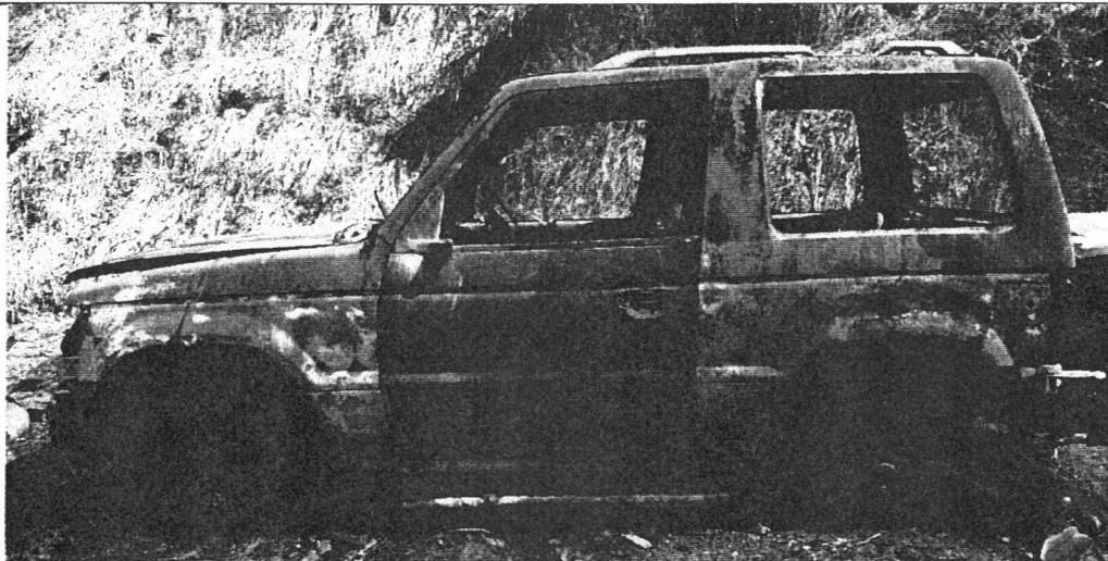
**Plano general:** Se aprecia parte lateral izquierda del vehículo tipo campero, donde se observa incineración total de los componentes, se evidencia pérdida total.
