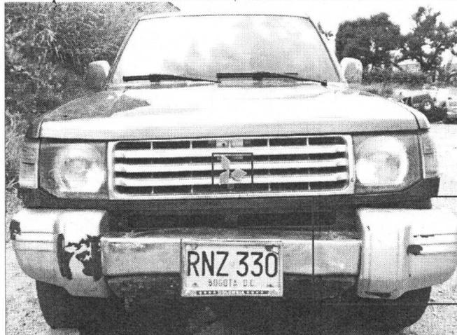
**Imagen N° 1:** En esta imagen se observa la parte anterior del vehículo tipo campero donde se aprecian recuadros en color rojo los cuales indican los daños presentados en el tercio anterior se observa desprendimiento del logo del Mitsubishi y del bomper parte izquierda : Conjunto en mal estado.
