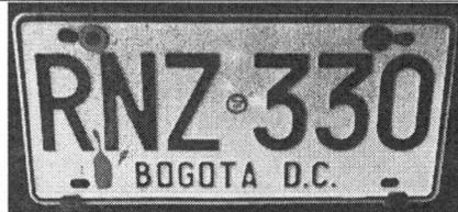
Imagen N° 29 y 30: En estas imágenes se observa la placa anterior y posterior de la matrícula del automotor RNZ 330 tipo campero, corresponde a la diferenciación de las demás de su clase y tipo; posee el aluminio, la cinta reflectiva, troquelados, cortes y demás, que cumple con la ficha técnica 001 del ministerio de transporte: Conjuntos en buen estado.
