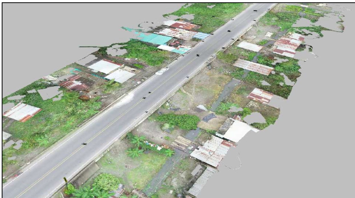
Imagen 4. Procesamiento de información topográfica obtenida con estación total de topografía y ortomosaico construido a partir de fotografías tomadas con UAV, procesadas en software FaroZone3D.
