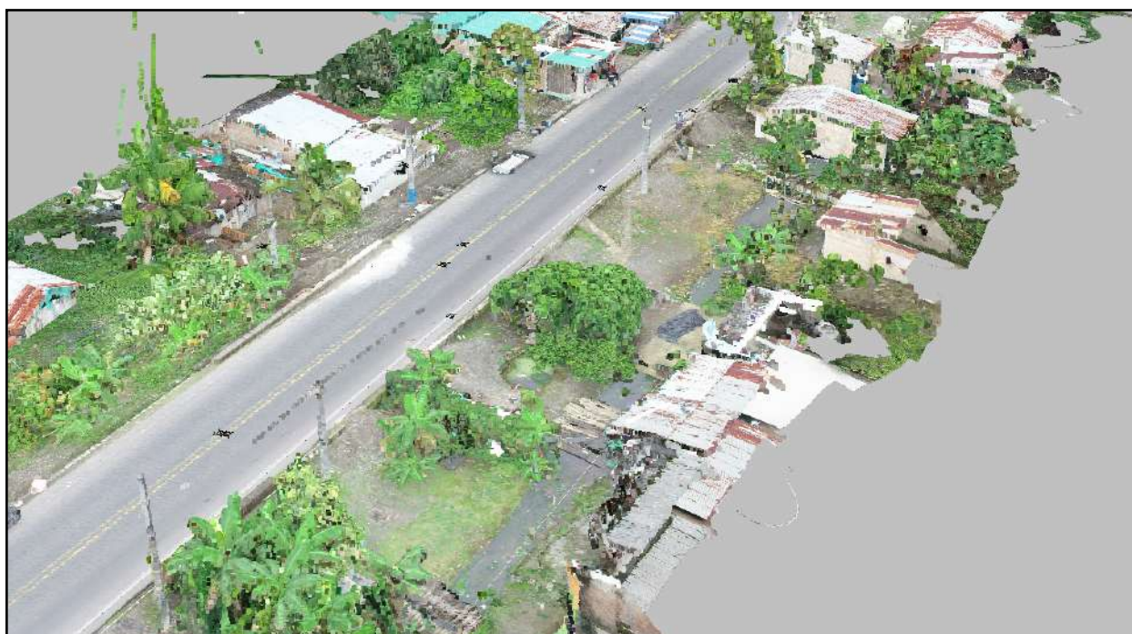
Imagen 5. Reconstrucción en tres dimensiones del lugar de los hechos a partir de información topográfica obtenida con estación total de topografía, ortomosaico y nube de puntos construidas a partir de imágenes tomadas con UAV; procesados en software FaroZone3D.
