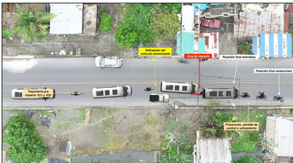
Imagen 29. Reconstrucción en tres dimensiones de la dinámica del accidente, se señalan las trayectorias pre impacto, zona donde los vehículos 1 y 2 realizaron el sobrepaso del vehículo 3 fuera de servicio, área de impacto por alcance del vehículo 2 microbús al 1 motocicleta, zona de proyección de la motocicleta donde se pierde el control derivando en volcamiento lateral izquierdo y posiciones finales.
