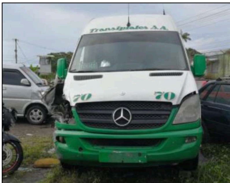
Imagen 23. Fotografía plano medio del vehículo (2) parte anterior, se observa abolladura con signos de roce en tercio derecho del parachoques anterior, desalojo y destrucción de farola derecha, desplazamiento de la tapa del capó hacia la izquierda, desalojo de placa de identificación vehicular delantera, deformación y hendidura profunda de guardafango anterior del lado derecho, desalojo de luz direccional derecha,
