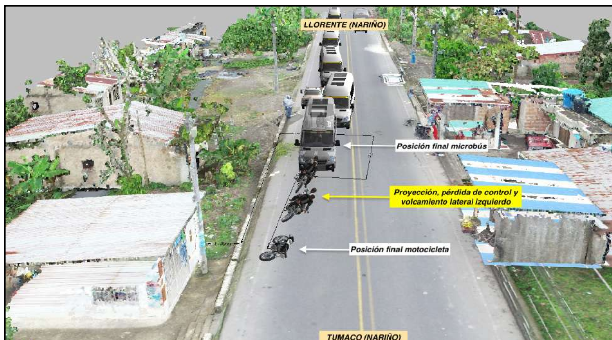
Imagen 32. Reconstrucción en tres dimensiones de la dinámica post impacto del accidente, se señala la zona de proyección, pérdida de control y volcamiento de la motocicleta en correlación con las posiciones finales.
