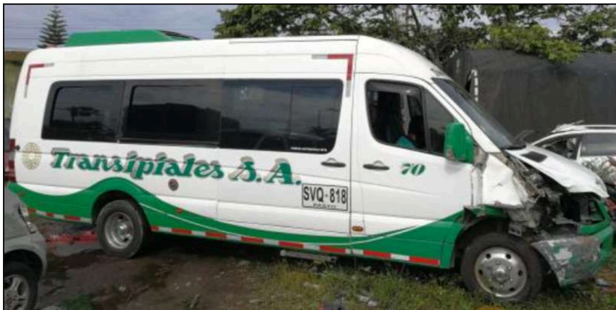
Imagen 20. Fotografía plano medio del vehículo (2) lado izquierdo, se observa abolladura en tercio derecho del parachoques anterior, desalojo y destrucción de farola delantera derecha, desalojo y destrucción de luz direccional derecha, deformación guardafango anterior derecho con desplazamiento y hendidura profunda hacia atrás, desalojo de segmento de tercio anterior de guardafango derecho delantero.
