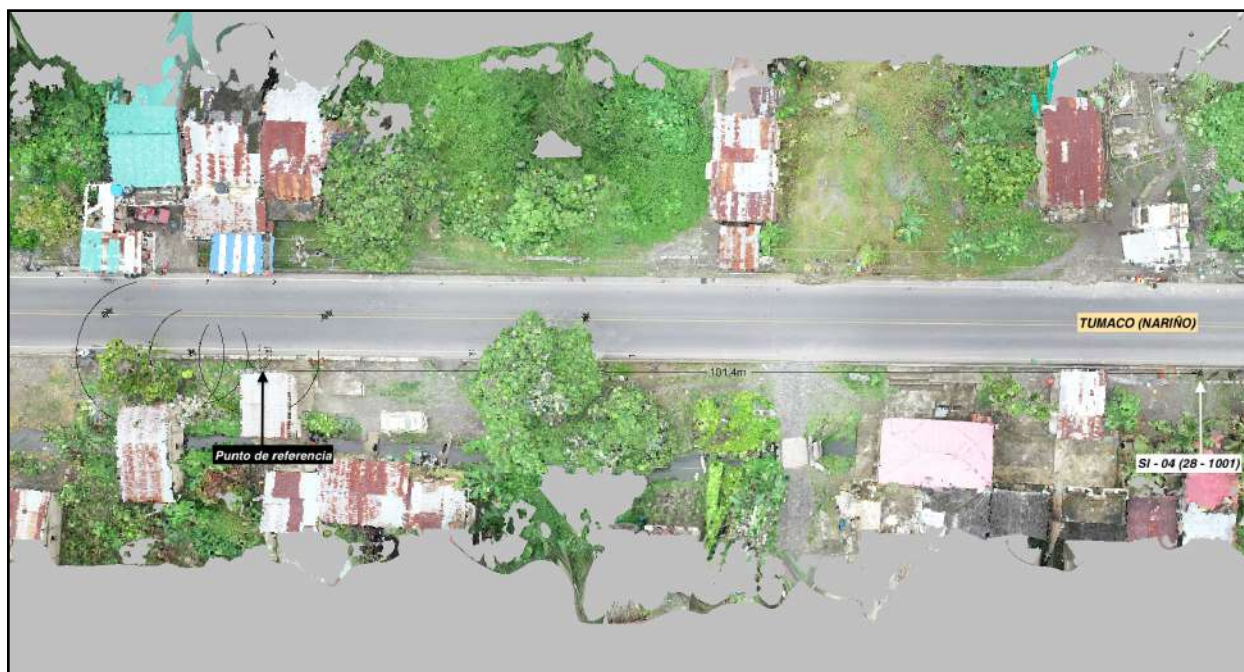
Imagen 13. Reconstrucción en tres dimensiones de la interpretación de las mediciones registradas en el IPAT, a la derecha de la imagen se posiciona la señal SI - 04 poste de referencia del Km 28, se tiene una medición de 101,4 metros desde éste hasta el punto de referencia utilizado para la fijación topográfica (poste utilitario).
