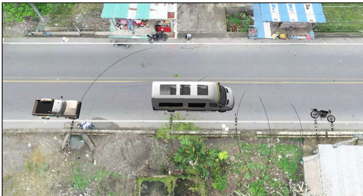
Imagen 17. Reconstrucción en tres dimensiones de las posiciones finales de los elementos materia de prueba, de acuerdo a las mediciones registradas en el Informe Policial de Accidente de Tránsito, no se fijaron huellas de ningún tipo en el lugar de los hechos, ni fragmentos de autopartes o rastros biológicos de las víctimas.
