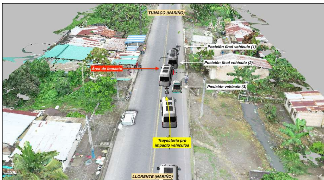
Imagen 30. Reconstrucción en tres dimensiones de la dinámica del accidente, se señalan las trayectorias pre impacto, posición del vehículo 3 fuera de servicio, área de impacto por alcance del vehículo 2 microbús al 1 motocicleta y posiciones finales.
