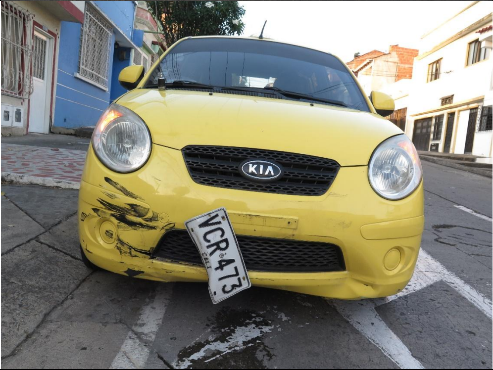
IMAGEN No. 14 Fijación fotográfica frontal del taxi de placas VCR-473 , se observan daños en la placa y bomper.
