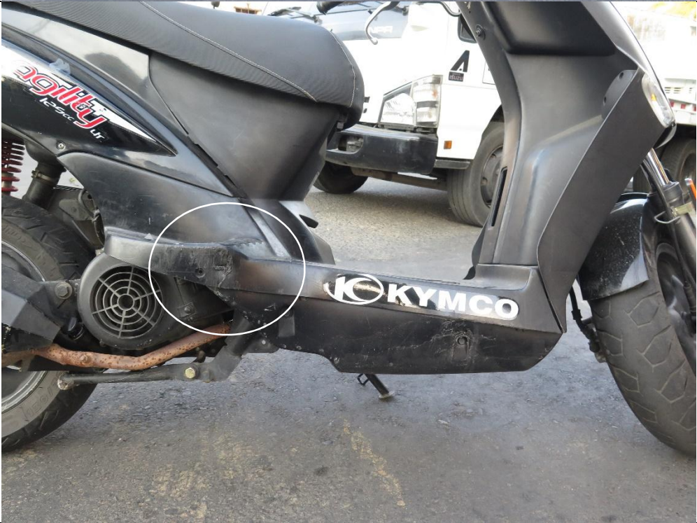
IMAGEN No. 13 Fijación fotográfica lateral derecha de la motocicleta de placa KPM-01B , presenta daños a la altura del calapie del pasajero.
