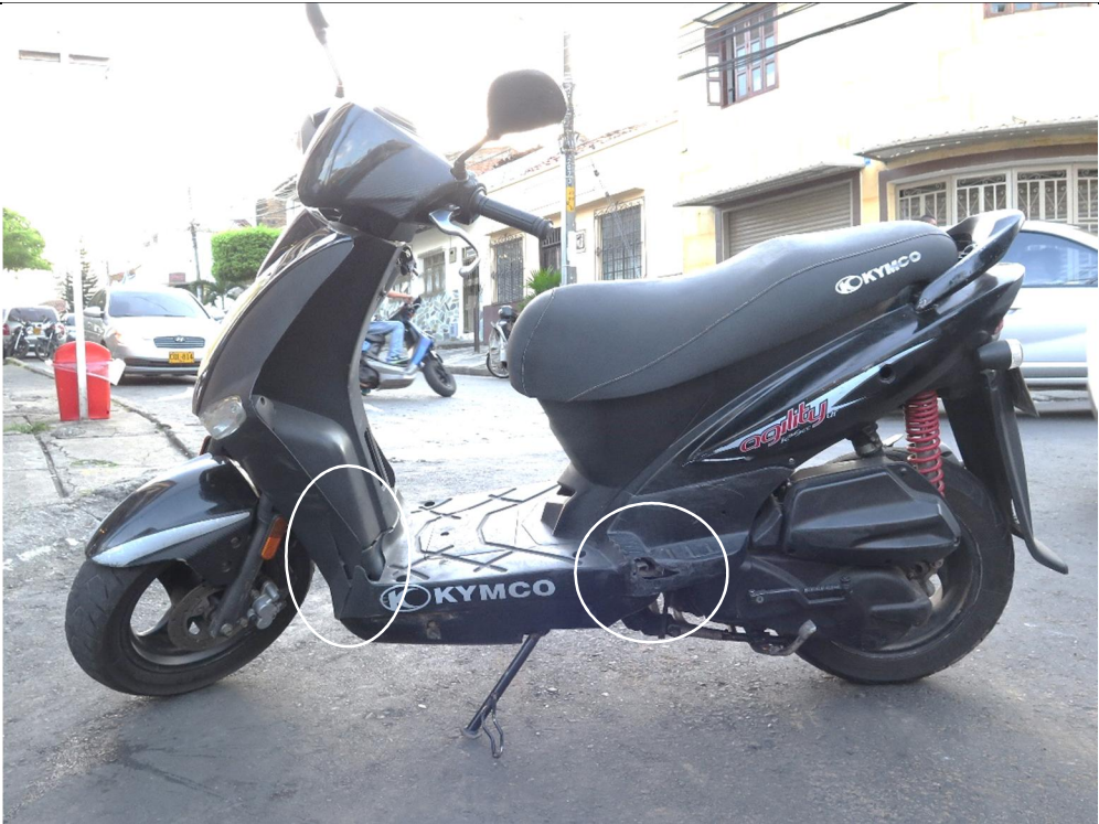
IMAGEN No. 12 Fijación fotográfica lateral izquierda de la motocicleta de placa KPM-01B , presenta daños en el calapie del pasajero y el babero.
