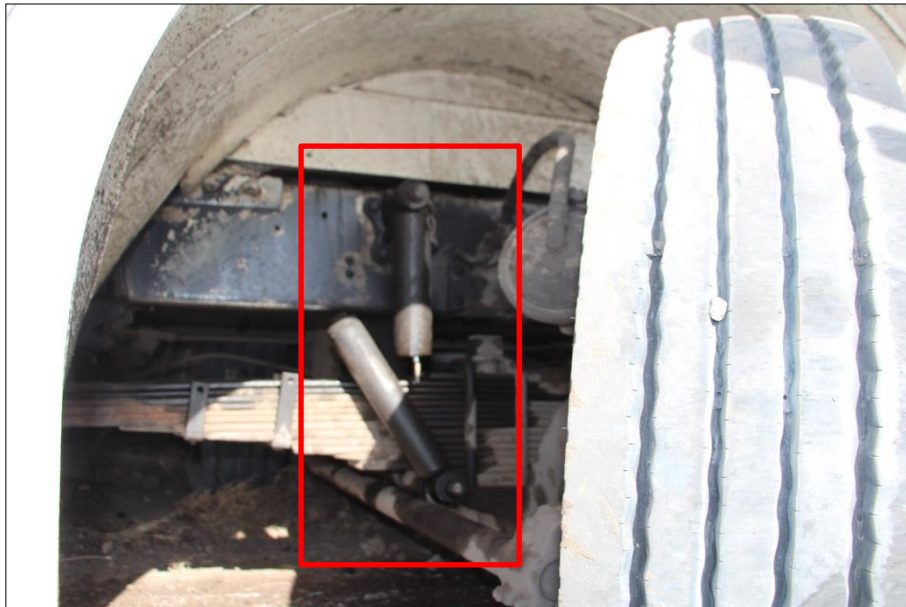
IMAGEN 23 PRIMER PLANO: En esta fotografía tomada a la suspensión de la parte anterior derecha del vehículo se aprecia dentro del cuadro de color rojo deformación y rotura de la botella de la suspensión.
