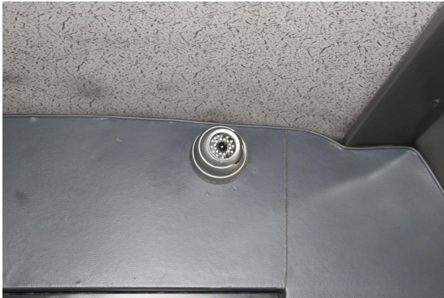
IMAGEN 29 PLANO MEDIO: En esta fotografía tomada al interior del vehículo se aprecia cámara de video ubicada en la parte posterior del vehículo la cual apunta desde la parte posterior hacia la parte anterior pero internamente vigilaría a los ocupantes del vehículo.
