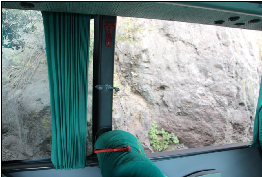
IMAGEN 32 PLANO MEDIO: En esta fotografía tomada al al interior del vehículo se aprecia martillos de seguridad para romper cristales laterales en caso de emergencia al parecer se hizo uso de ellos por los ocupantes del vehículo.
