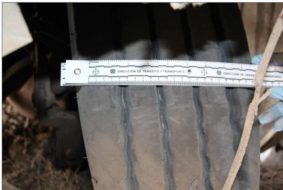
IMAGEN 24 PRIMER PLANO: En esta fotografía tomada a una de las llantas del vehículo la cual mide 22 c.m de ancho y se aprecia el estado de vida de la llanta.
