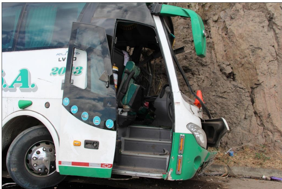
IMAGEN 21 PLANO MEDIO: En esta fotografía tomada a la parte anterior del vehículo costado derecho se aprecia la posición de las llantas y demás daños ocasionados al vehículo
