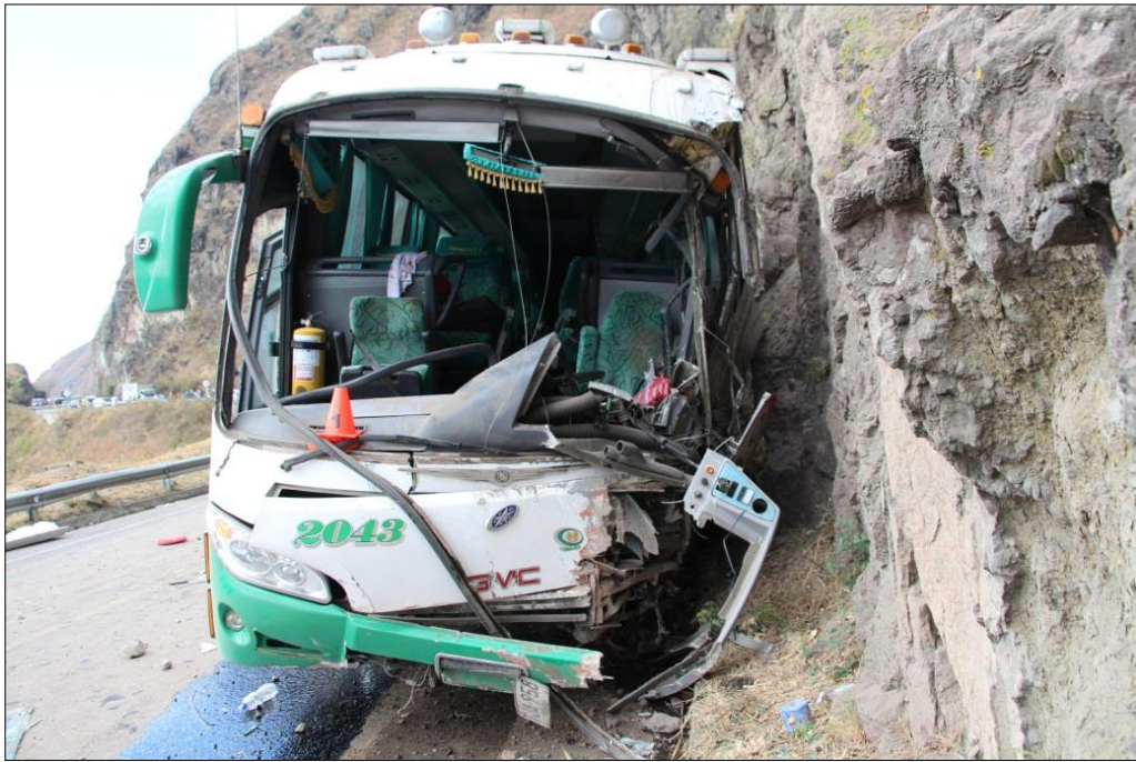
IMAGEN 19 PLANO MEDIO: En esta fotografía tomada en sentido vial Mojarras hacia Pasto se aprecia los daños ocasionados a la parte anterior del vehículo después del impacto contra las rocas.
