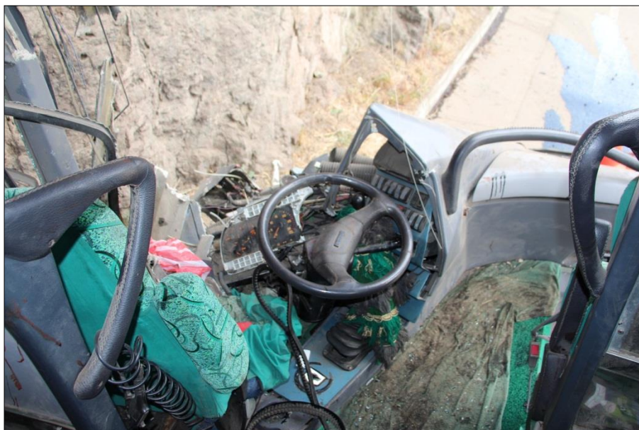
IMAGEN 25 PRIMER PLANO: En esta fotografía tomada al habitáculo del conductor se aprecia deformaciones del volante y demás paneles de instrumentos, inexistencia de vidrios panorámicos y demás daños graves.
