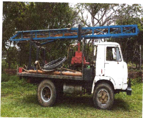
Imagen 25. Detalle movilización de equipo de perforación para construcción pozo profundo vereda San isidro.
