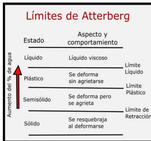
Ilustración 34. Esquema del comportamiento del suelo según los límites de Atterberg. Fuente: Google.
