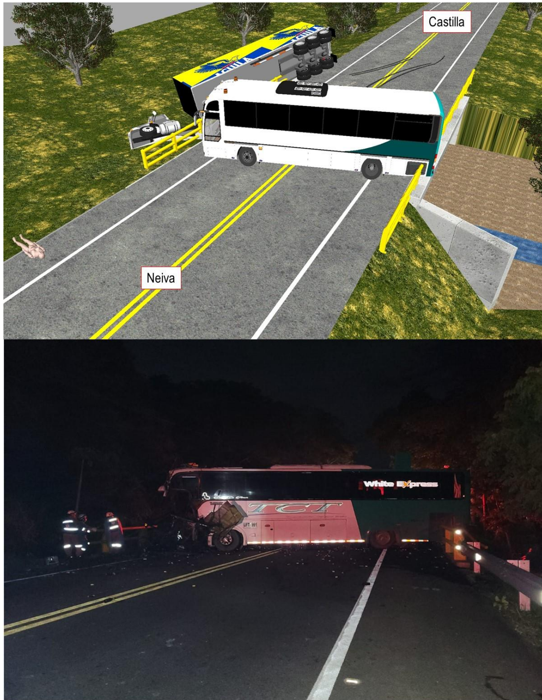
Imagen No.22: Imagen compuesta de vista en 3D de la elaboración a escala en el software Trimble Reveal, versus fotografía aportada para el análisis del caso.
