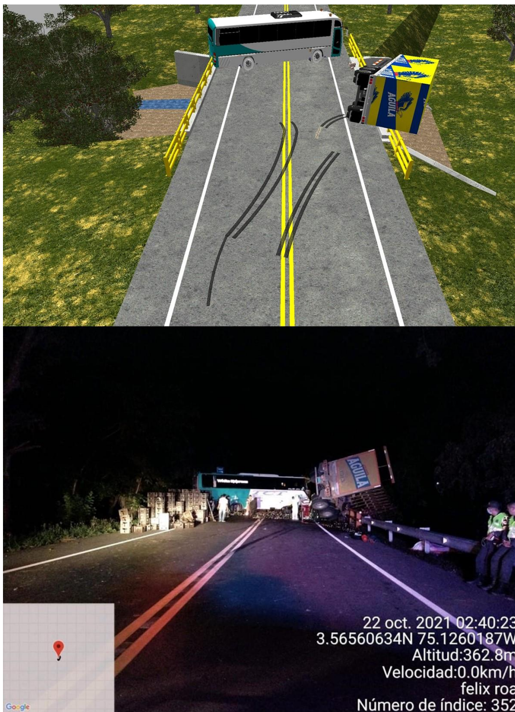
Imagen No.21: Imagen compuesta de vista en 3D de la elaboración a escala en el software Trimble Reveal, versus fotografía aportada para el análisis del caso.
