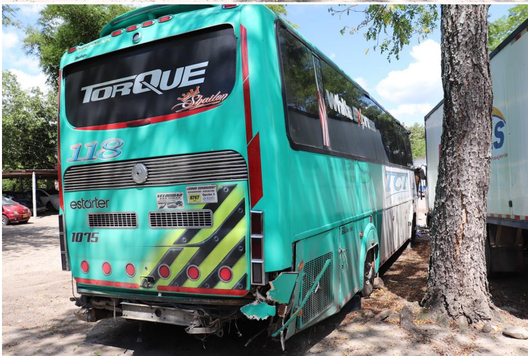
Fotografías No. 17 y 18: Se observa los daños presentes en el automotor en la zona posterior del automotor, compatibles con un segundo impacto en el accidente de tránsito.
