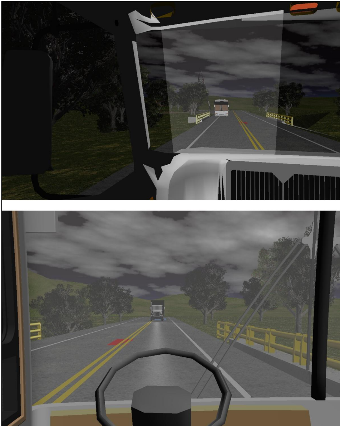
Imagen No. 31: En estas otras imágenes vistas en perspectiva 3D, se aprecia se observa la visibilidad de los conductores al momento del inicio de la reacción por parte del conductor del vehículo No.1 Tractocamión.
