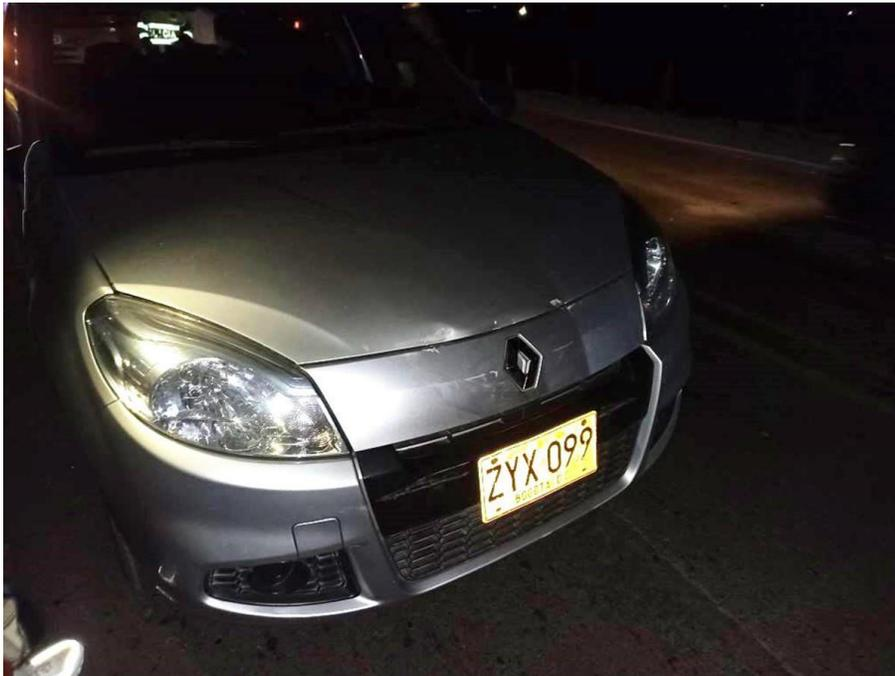
**Fotografía No. 5 Plano Medio:** En estas fotografías se observa el estado final del vehículo, el cual presenta daños en su zona posterior, afectando piezas como: quinta puerta, panorámico y paragolpes posterior, así como en la zona anterior afectando piezas como: paragolpes y capó.
