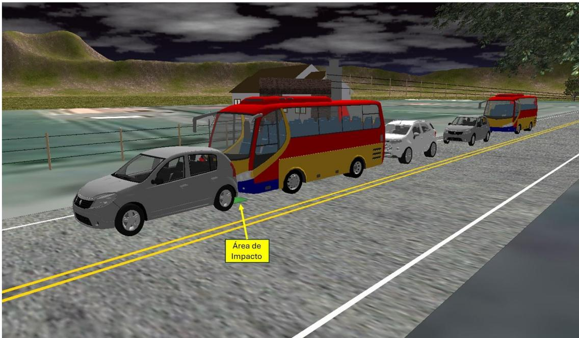
**Imagen No. 27:** En estas imágenes, vista en planta y 3D se aprecia la secuencia del accidente antes y al momento del primer impacto, nótese el sentido de desplazamiento de los vehículos y el área donde se presenta en la vía. Elaboración a escala en el software Trimble Forensics Reveal.
