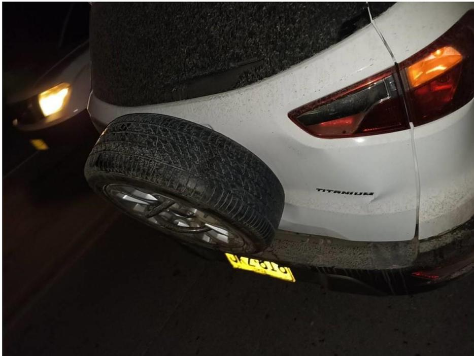
**Fotografía No. 4 Plano Medio:** En estas fotografías se observa el estado final del vehículo, el cual presenta daños en su zona posterior, afectando piezas como: quinta puerta y llanta de repuesto.
