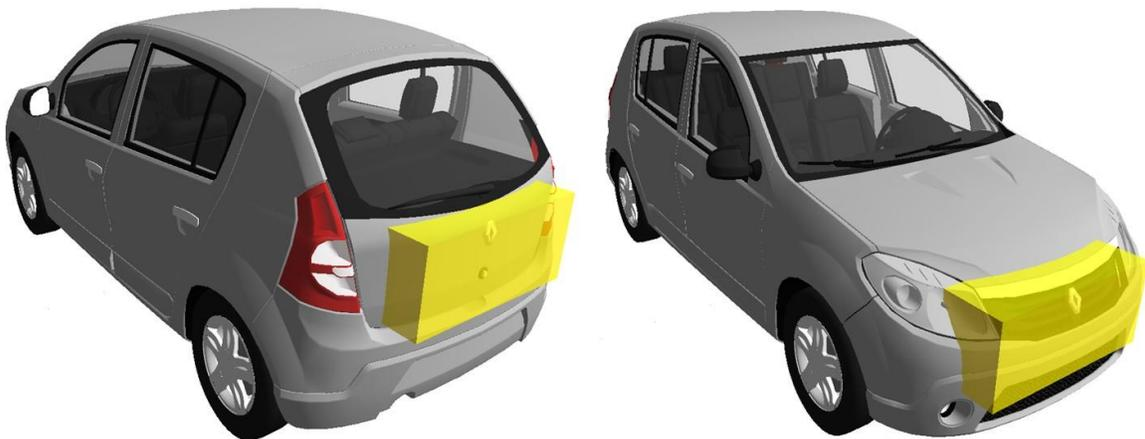
**Imagen No. 11:** En esta imagen se observa con los recuadros amarillos la ubicación de los daños o evidencia en el automóvil. Elaboración a escala en el software Trimble Forensics Reveal.
