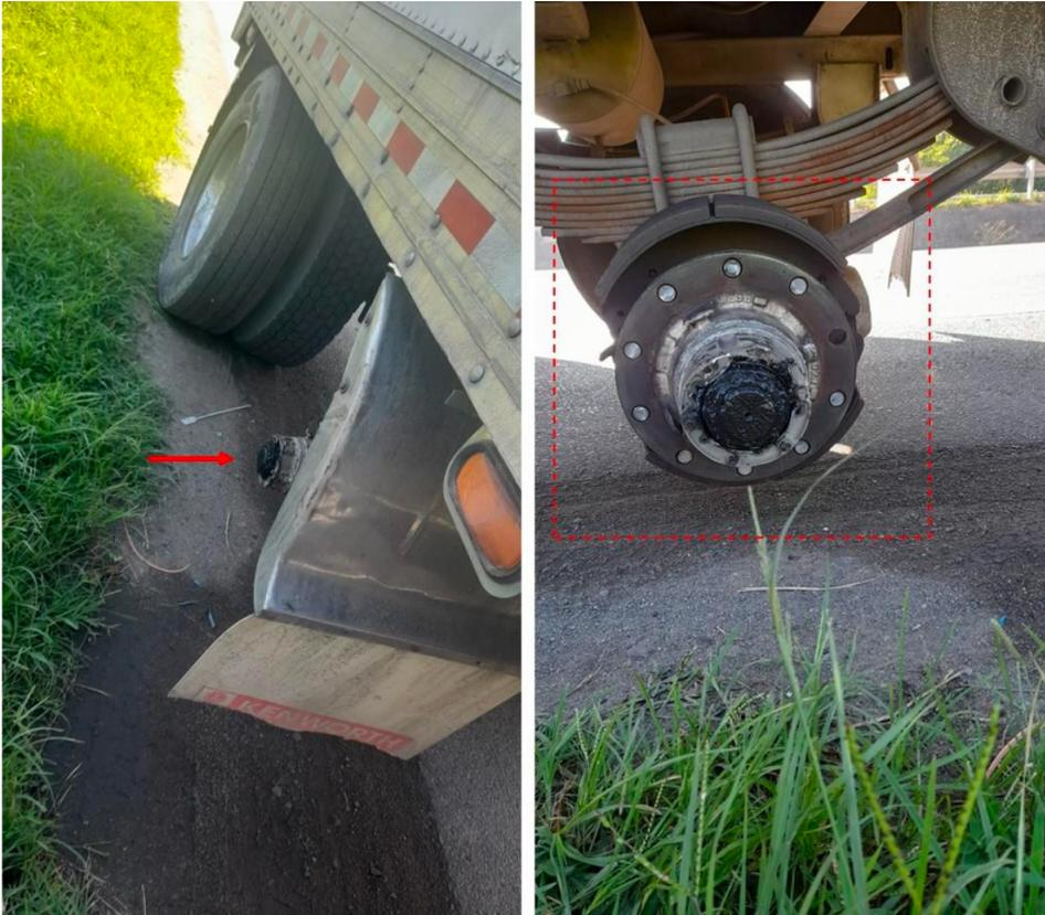
**Fotografía No.7:** Compuesta por registros fotográficos del día de los hechos se observa el estado final del primer eje costado lateral derecho del semirremolque compatible con: ausencia del conjunto de ruedas.
