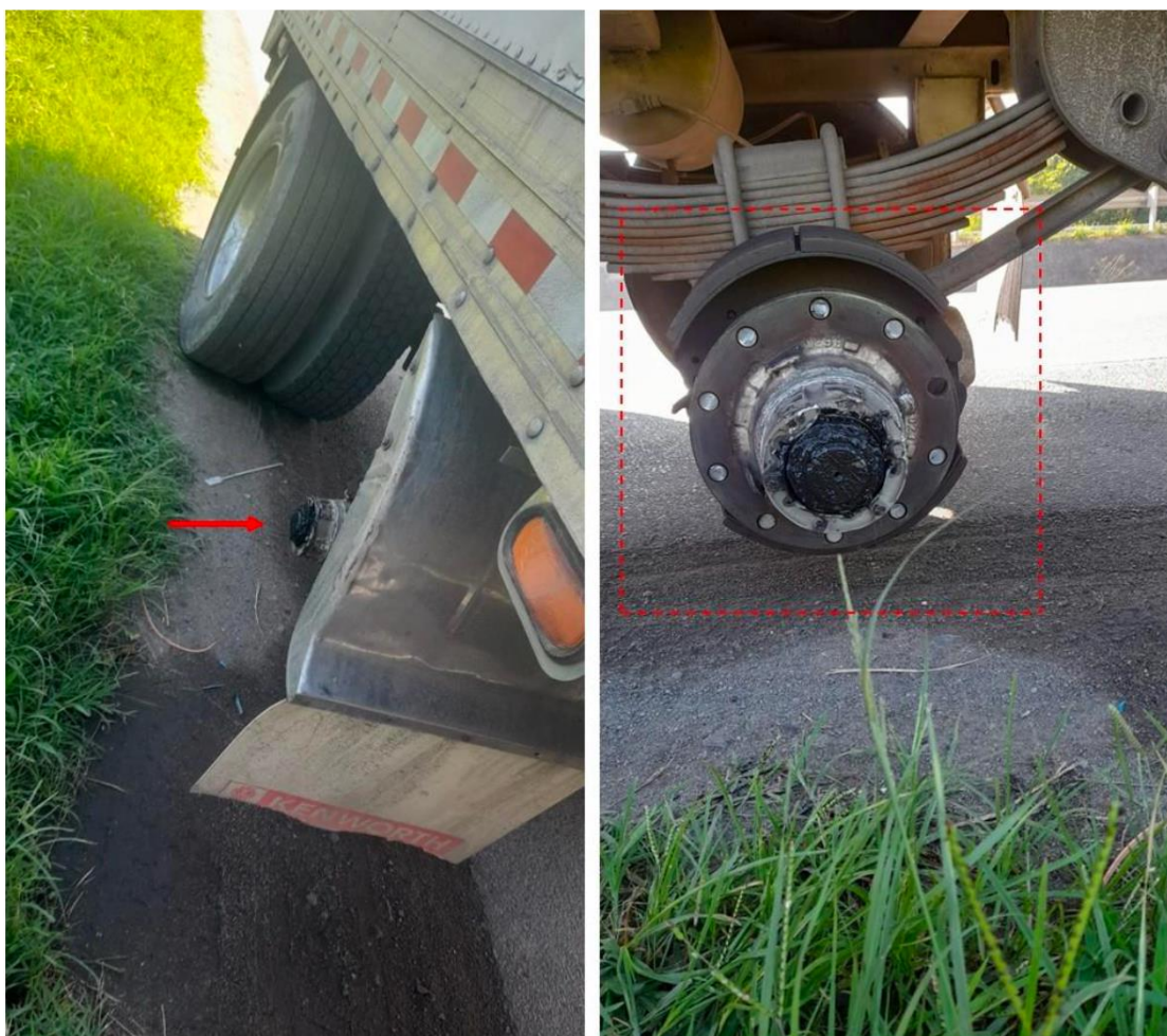
Imágenes No. 10 – 11. Material fotográfico disponible del daño en los espárragos o pernos de fijación
