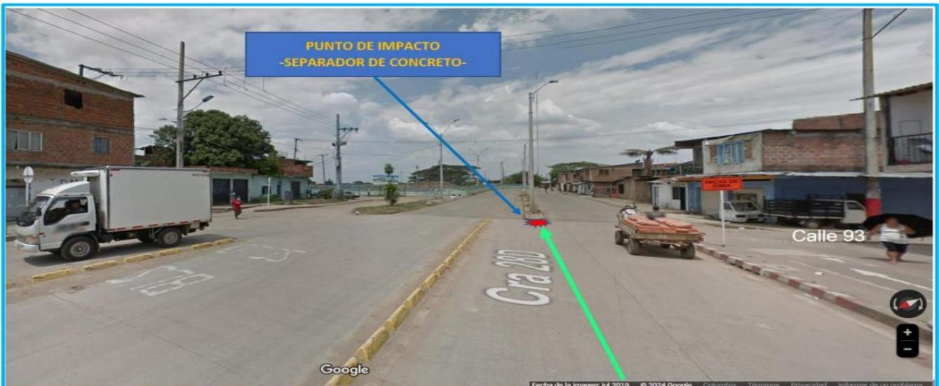
*Imagen N°5. Demarcación y señalización: Líneas tenues de sentido vial y de solo bus, ciclovía en andén; sin señalización para calzadas vehiculares, sin prevención de obstáculo (Imagen Google Maps julio de 2019)*
