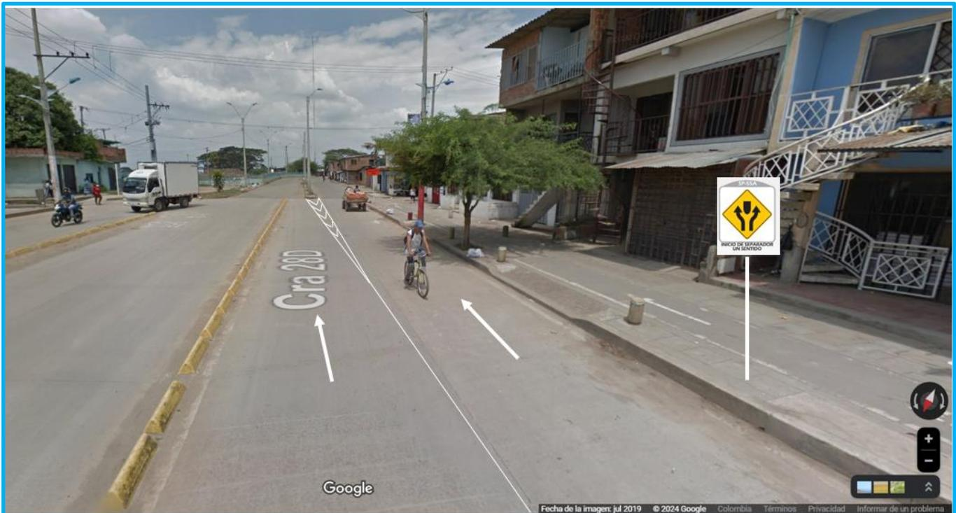
Imagen 17. CARRERA 28D CALLE 93. Señalización y demarcación requerida en la intersección ante la presencia del obstáculo -separador-. (Imagen Google Maps -julio de 2019 -recreación-)
