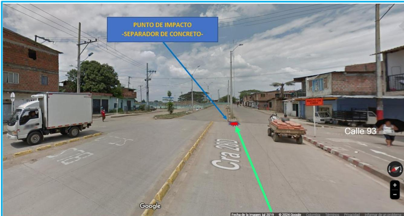
Imagen N°5. Demarcación y señalización: Líneas tenues de sentido vial y de solo bus, ciclovía en andén; sin señalización para calzadas vehiculares, sin prevención de obstáculo (Imagen Google Maps julio de 2019)
