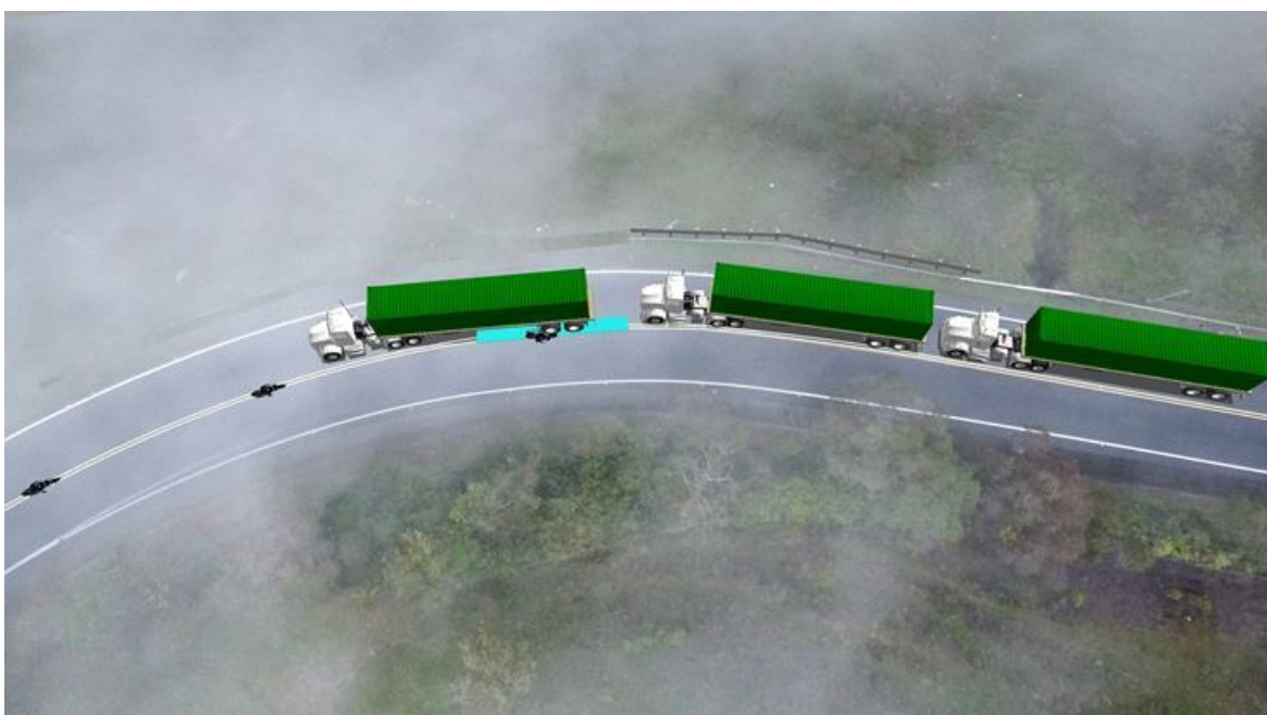
Imagen No. 21: En estas imágenes vistas en planta se aprecia la secuencia de los vehículos antes del impacto, la posición relativa de los automotores al momento de la colisión, y el área de color azul donde se presentó el choque.
