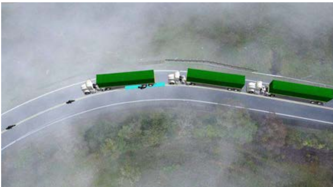
Imagen No. 21: En estas imágenes vistas en planta se aprecia la secuencia de los vehículos antes del impacto, la posición relativa de los automotores al momento de la colisión, y el área de color azul donde se presentó el choque.
