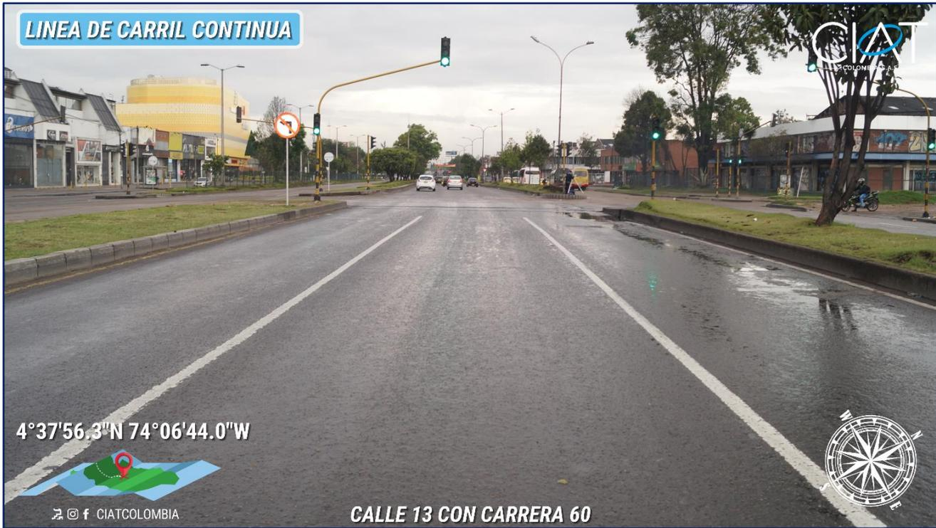
**IMAGEN 8.** En la imagen se aprecia la demarcación “Linea de carril continua” sobre el eje central de la calzada.
