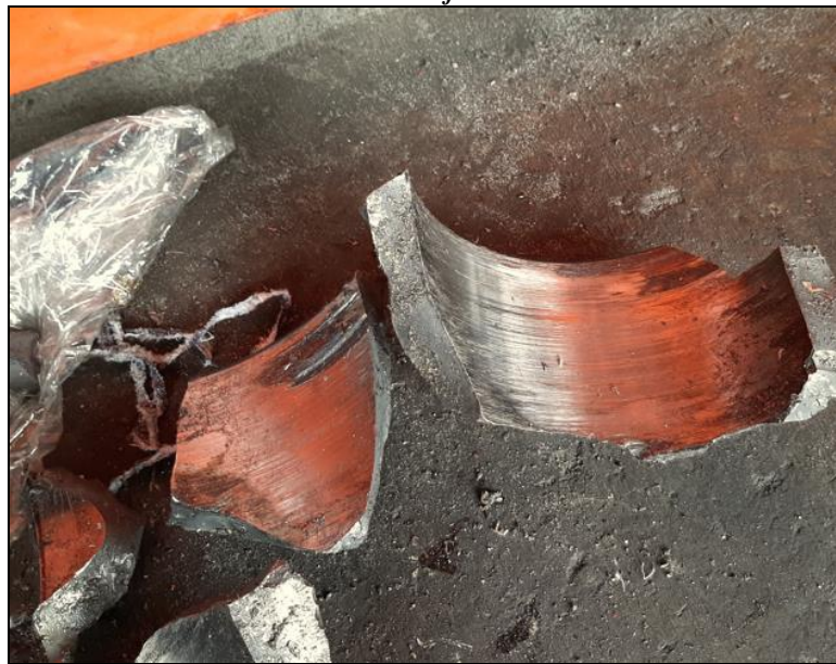
Pista interior Fracturada
