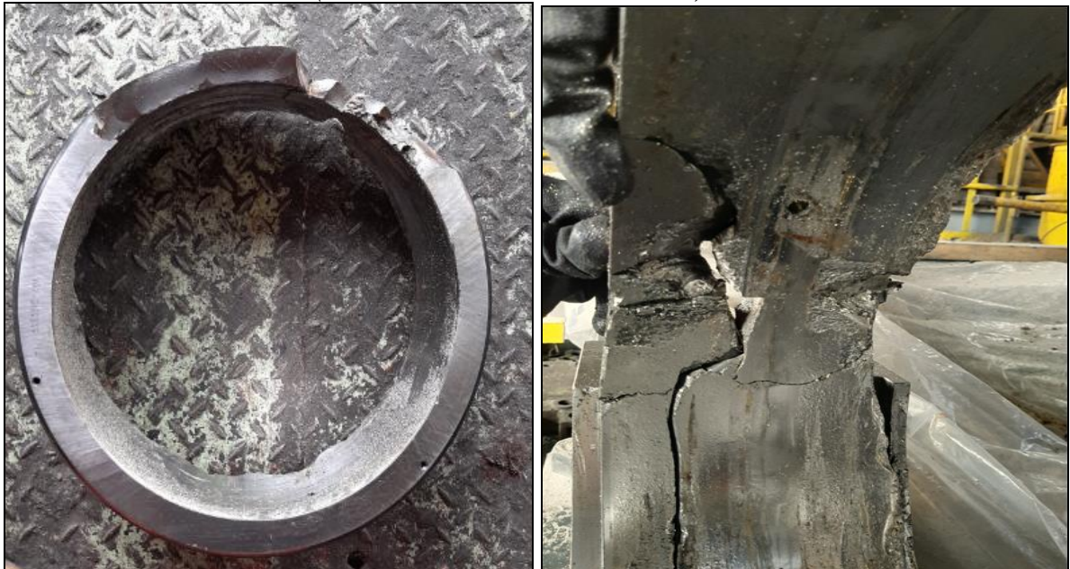
Pista exterior fracturada
