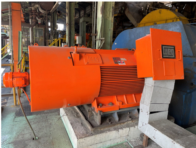
Motor eléctrico WEG, para accionamiento del molino N° 6
