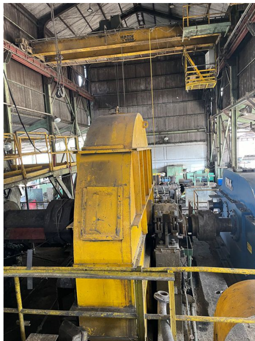
Sistema de transmisión del molino N° 6
