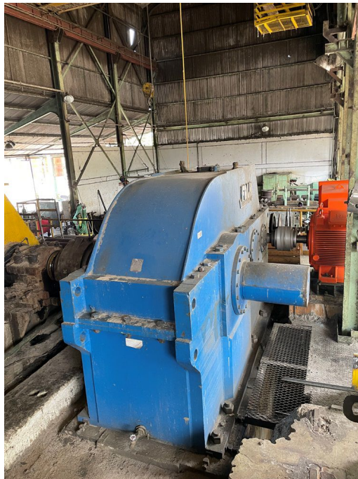
Reductor de velocidad del molino N° 6, marca Falk, de 700 HP.
