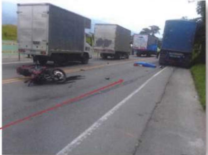
Imagen 21. Muestra la trayectoria post-impacto de los vehículos participantes. El vehículo de mayor inercia traslada los EMP Y EF, hacia su carril natural. El tracto camión es el vehículo de mayor inercia.
