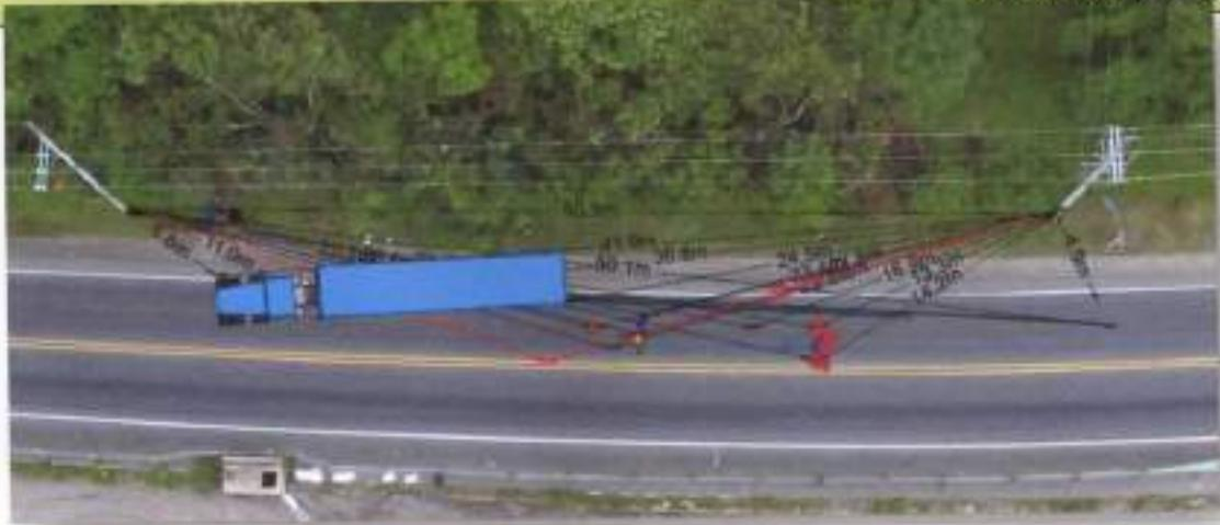
Imagen 25. Se observan con mayor detalle la medición realizada por policía judicial. Las líneas negras son las respectivas cotas en el relevamiento de las evidencias y elementos materia de prueba. La medición con color rojo no corresponde a la realidad.
