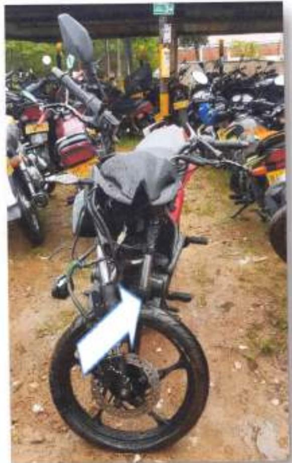
Imagen 16. muestra. La trayectoria de impacto que presento la motocicleta. La flecha blanca incide como el tracto camión impacta con la motocicleta.
