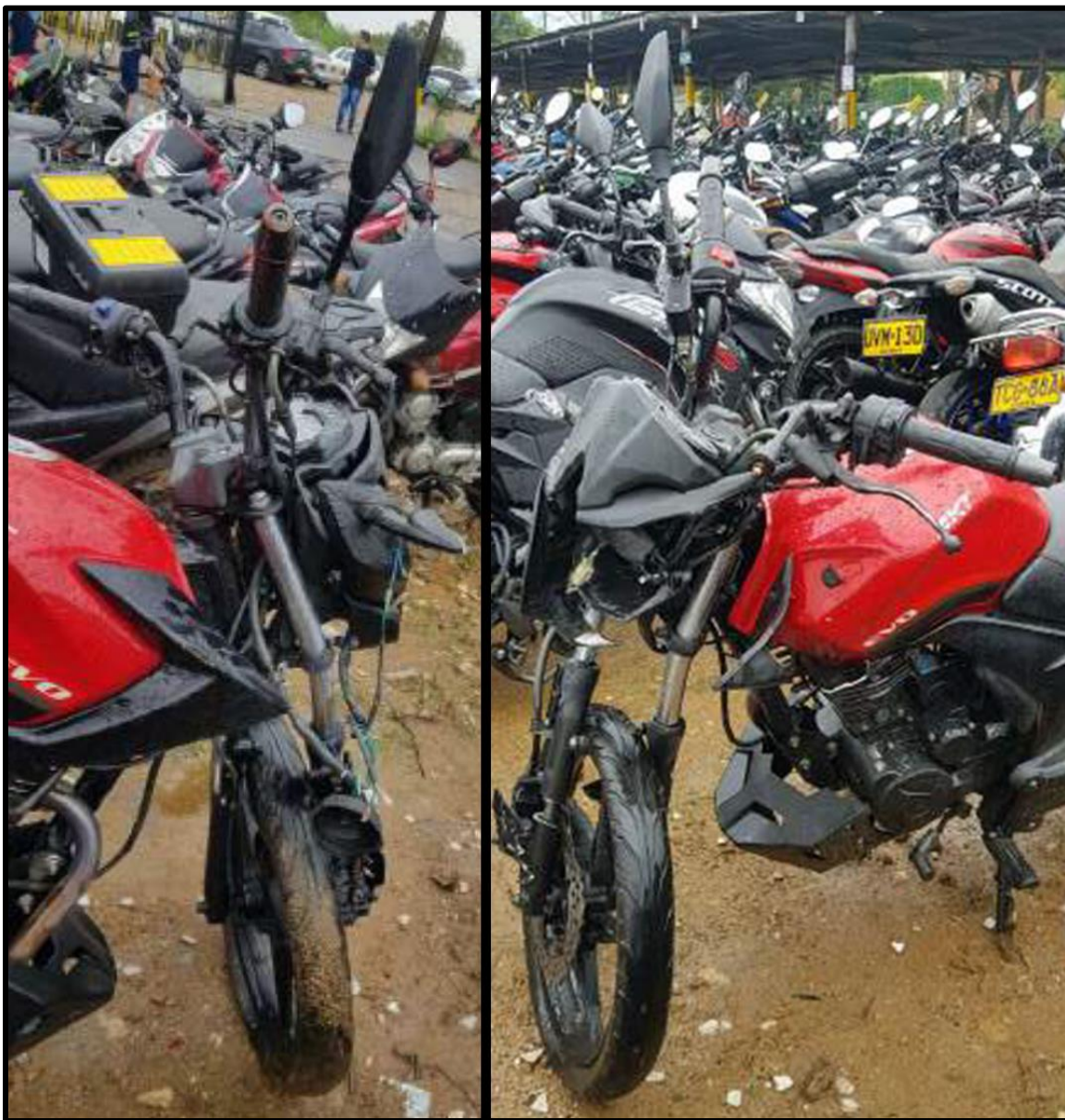
Fotografías No. 12 y 13: En estas fotografías se aprecian los daños en la zona frontal de la motocicleta, afectando los componentes del tren delantero.
