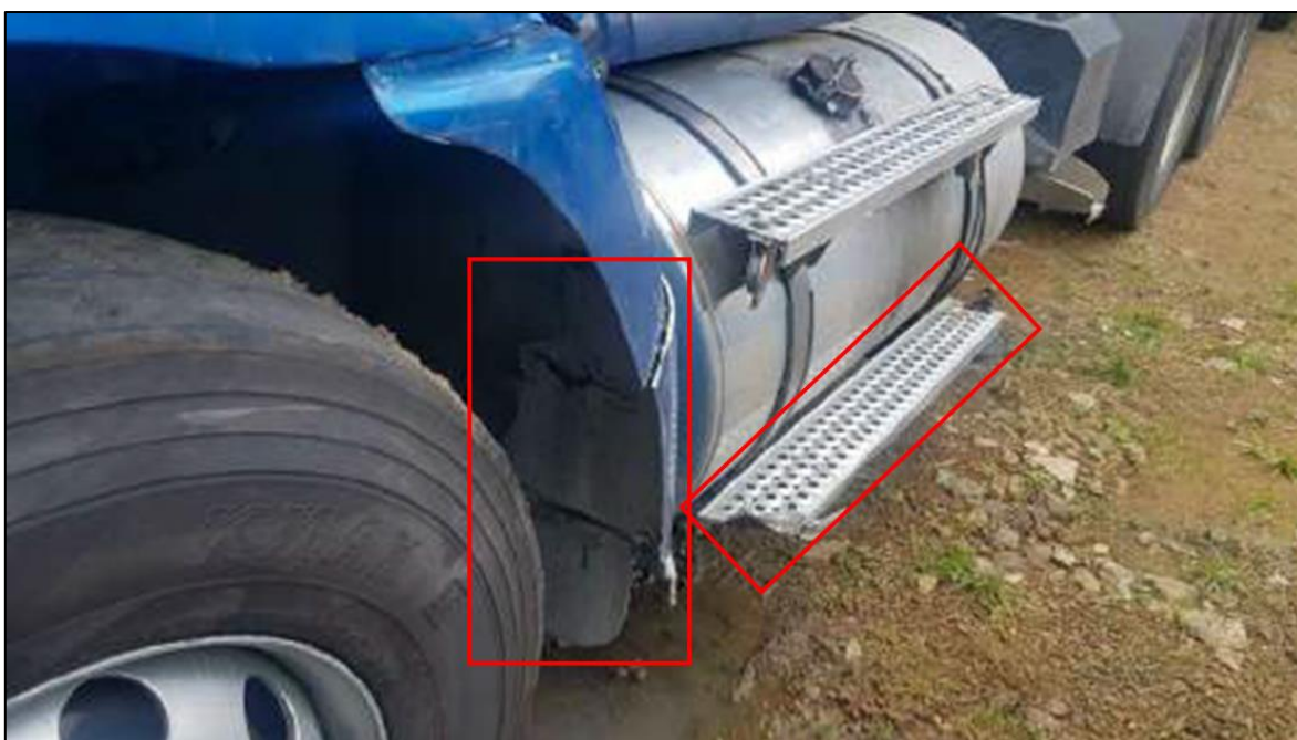
Fotografías No. 6 y 7: En estas fotografías se aprecia la zona de daños del tractocamión ubicada en la zona lateral izquierda tercio anterior, afectando guardafangos, y estribo inferior.
