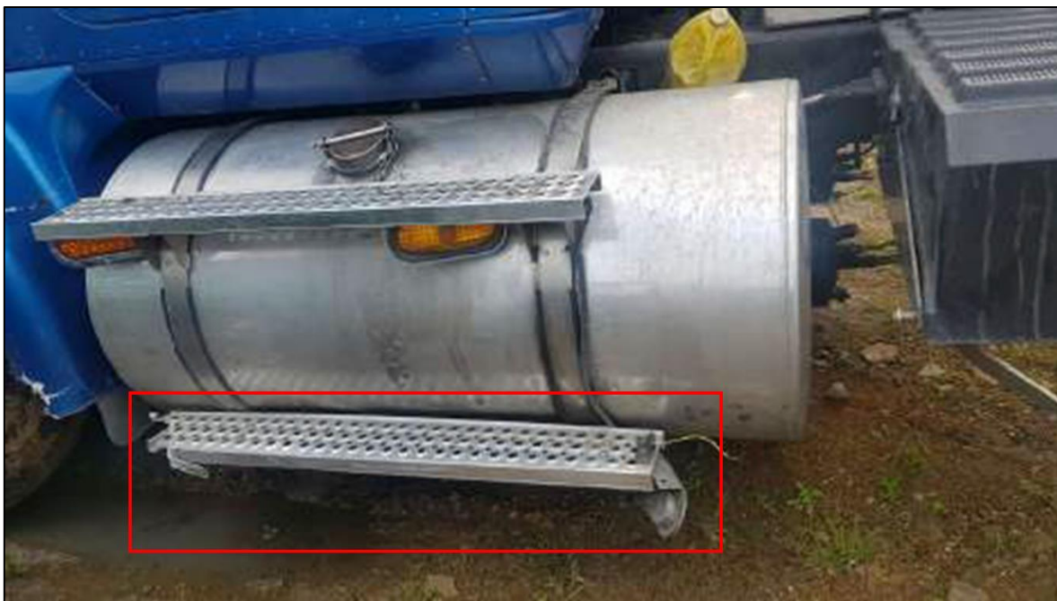
Fotografías No. 8 y 9: En estas fotografías se aprecian las deformaciones en el guardafangos, y estribo inferior.
