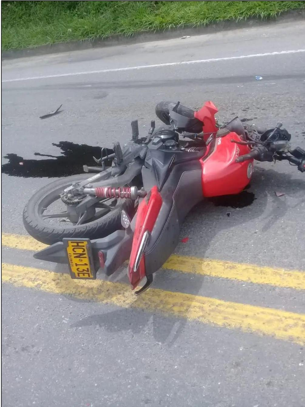
**Fotografía No. 15:** En esta fotografía se aprecia la posición final de la motocicleta; nótese que solo se observa sobre el asfalto la huella marcada por la rueda posterior izquierda del semirremolque del tractocamión, más no se perciben huellas marcadas con la rueda posterior derecha.
