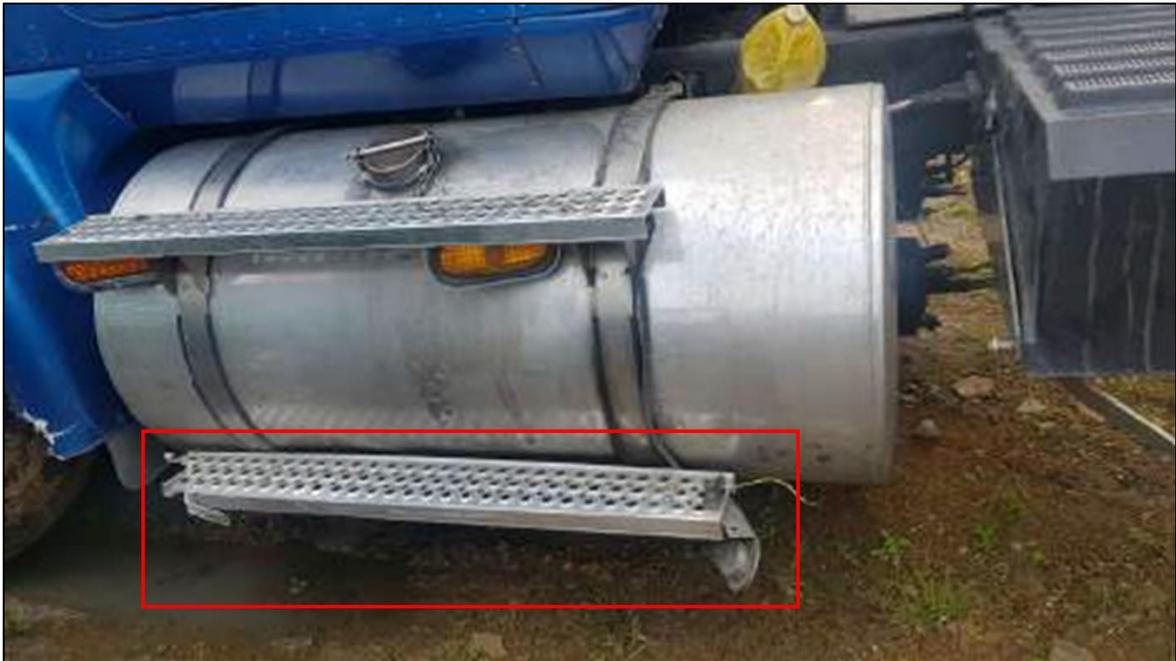
**Fotografías No. 8 y 9:** En estas fotografías se aprecian las deformaciones en el guardafangos, y estribo inferior.
