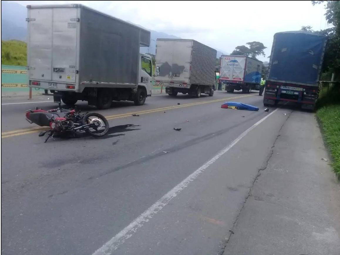
**Fotografía No. 14:** En esta fotografía se aprecia la posición final del tractocamión, la motocicleta, el occiso, la huella de frenado, y vestigios sobre la vía; es importante tener en cuenta que no se observa en la vía huella de frenado marcada con la rueda posterior derecha como se indica en el croquis del IPAT.
