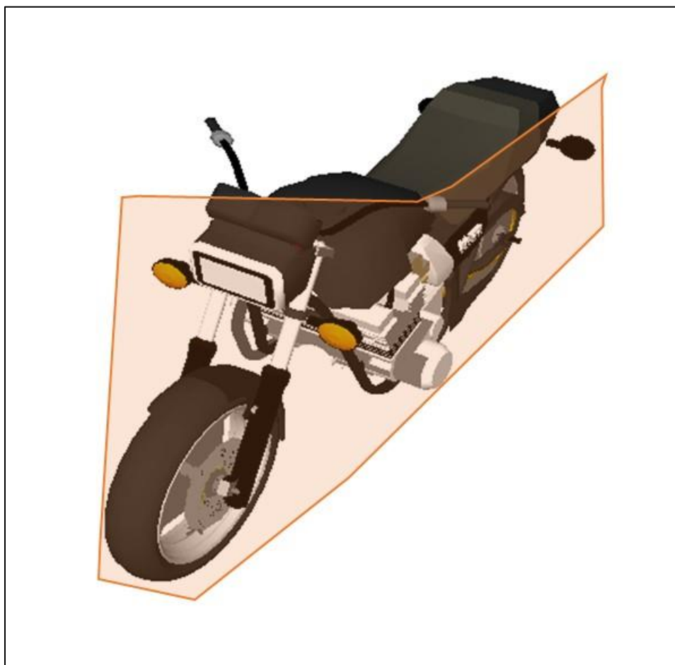
Imagen No.10: En esta imagen basada en los reportes se resalta la zona de daños y evidencias en el vehículo. Software Trimble Forensic Reveal.
