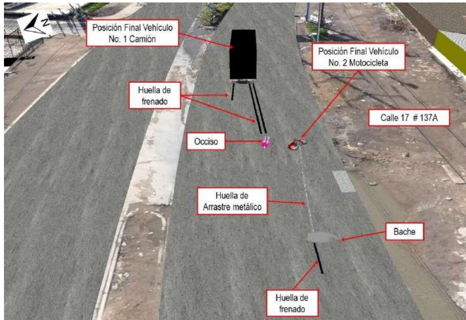
Imagen No.10: Imagen compuesta de vista en 3D de la elaboración a escala en el software TRIMBLE FORENSICS REVEAL, del bosquejo elaborado por la autoridad de tránsito.
