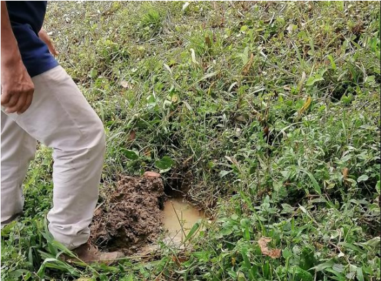
Imagen 25: Brote de agua al momento de realizar alguna excavación no profunda.
