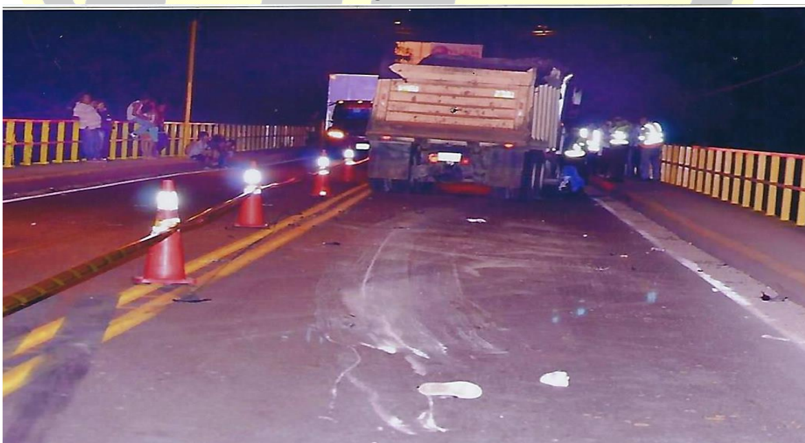
Fotografía de la madrugada del accidente en cuanto huella de frenado de la volqueta y huella arrastre de la motocicleta de placa JML57E.
