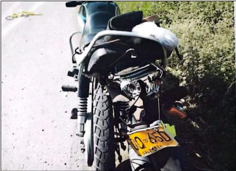
Figura N° 8: imagen tomada del álbum fotográfico, donde se observa el daño parte trasera en el vehículo #2
