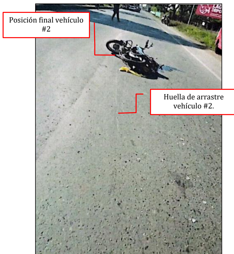
Figura N° 12: imagen del álbum fotográfico donde se ilustra la posición final del vehículo #2 Motocicleta marca Honda, modelo Eco Deluxe, color negro, Placa FOQ 65D; y su huella de arrastre.
