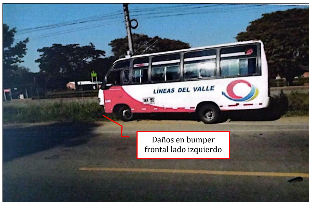
Figura N° 5: imagen tomada del álbum fotográfico, donde se observa el daño en el bumper frontal lado izquierdo del vehículo #1 Buseta Non Plus Ultra, color Blanco1, Placa VKK 192.
