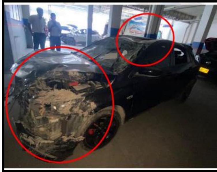
En esta imagen se puede observar el costado izquierdo del vehículo de placas EHR – 666, evidenciando que el bomper delantero se encuentra desprendido y roto, el capot presenta con abolladuras, hundimientos y rayones, el techo presenta abolladuras y hundimientos.
