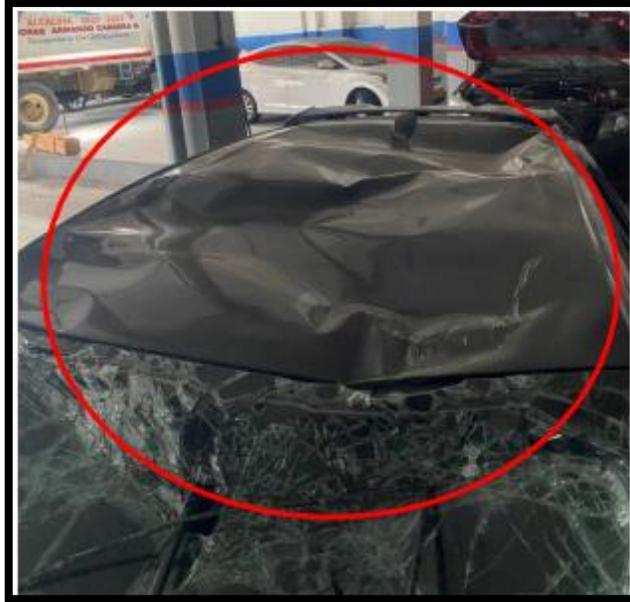
Se puede observar el techo del vehículo asegurado que presenta abolladuras, hundimientos y rayones, el vidrio panorámico delantero fragmentado.
