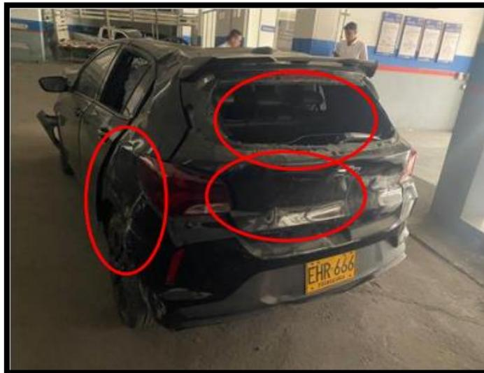
En la parte posterior del vehículo asegurado se evidenció que la puerta del baúl presenta abolladuras hundimientos y rayones, observando ausencia del vidrio panorámico trasero, con rayones en la aleta trasera izquierda y bomper.
