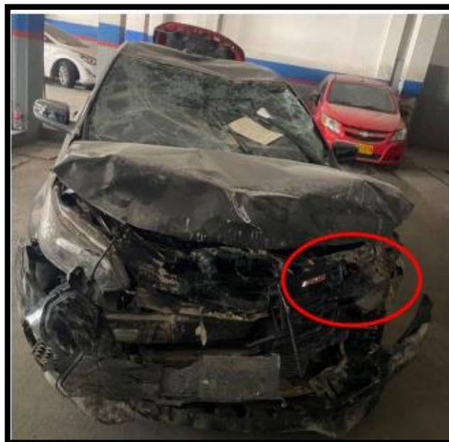
En esta imagen se puede observar el vehículo de placas EHR – 666, al momento de la inspección, evidenciando que la parte frontal del rodante se encuentra con abolladuras, hundimientos y rayones, el vidrio panorámico delantero se encuentra fragmentado, la unidad izquierda se encuentra rota.
