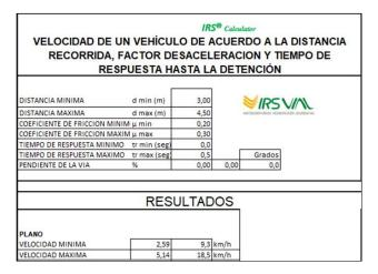
**Imagen No. 25:** En esta imagen se observa el desarrollo de los cálculos realizados con la herramienta *IRS*<sup>®</sup> *Calculator*.
