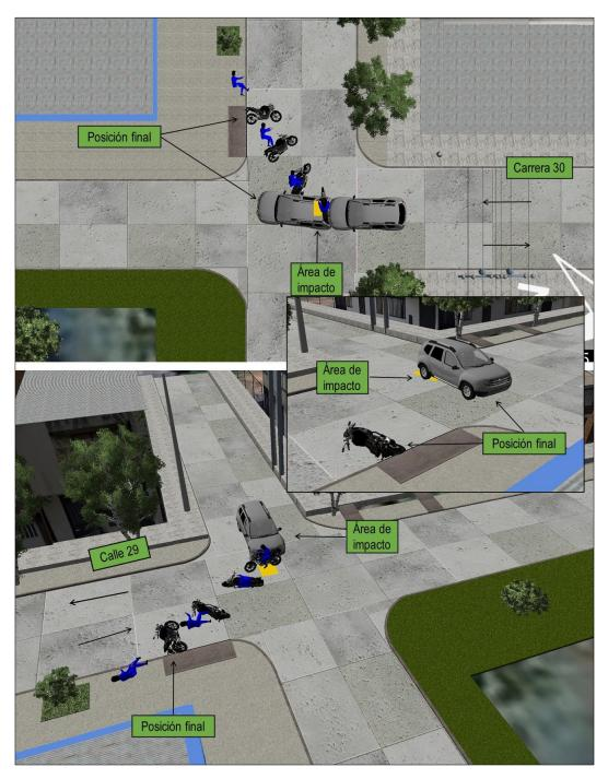
**Imagen No. 30:** En estas imágenes vista en planta y 3D se referencia la secuencia probable de accidente, nótese la posición relativa sobre la calzada, el área donde se presenta y el desplazamiento de los vehículos hasta sus posiciones final. Elaborada en el software Trimble Forensic Reveal.
