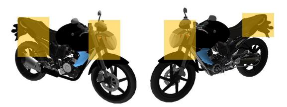
**Imagen No. 12:** En esta imagen basada en los reportes se resalta la zona de daños y evidencias en el rodante. Elaboración en el software Trimble Forensic Reveal.
