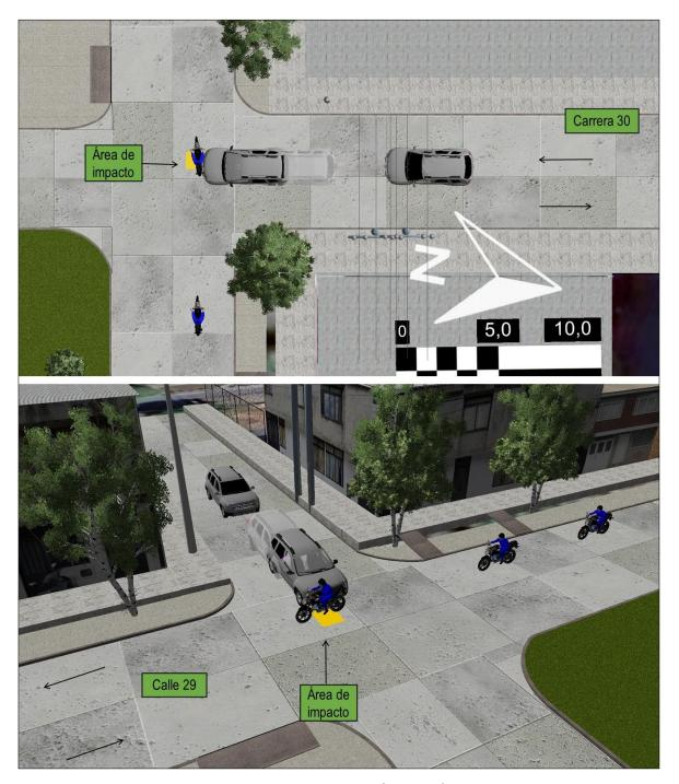
**Imagen No. 29:** En estas imágenes vista en planta y 3D se referencia la secuencia probable de accidente, relacionando rutas de aproximación hasta el lugar de impacto Elaborada en el software Trimble Forensic Reveal.
