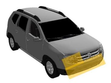
**Imagen No. 8:** En esta imagen basada en los reportes se resalta la zona de daños y evidencias en el rodante. Elaboración en el software Trimble Forensic Reveal.
