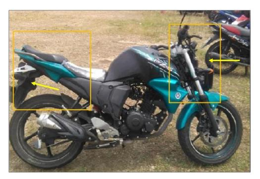
**Imagen No. 16:** En esta imagen se observa el estado final de la zona lateral derecha del vehículo No. 2, donde se evidencia el desplazamiento del guardabarro y el desalojo del carenaje anterior.
