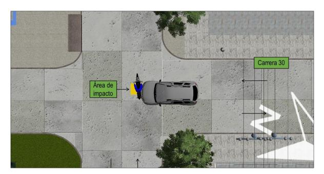
**Imagen No. 23:** En esta imagen vista en planta se muestra la posición relativa de los vehículos al momento del impacto y el área donde se presentó, elaborada en el software Trimble Forensic Reveal.
