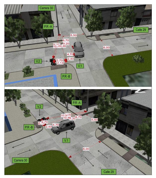
**Imagen No. 19:** Imagen compuesta de vista en 3D de la elaboración a escala en el software Trimble Forensic Reveal, se observa la posición final de los vehículos, las medidas (cotas) tomadas por la autoridad.
