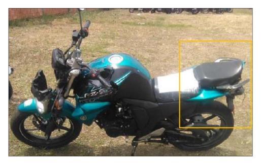
**Imagen No. 15:** En esta imagen se observa el estado final de la zona lateral izquierda del vehículo No. 2, donde se evidencia que tiene rotura de la tapa cola izquierda, stop y trasero.
