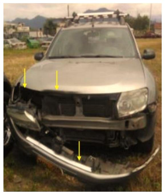
**Imagen No. 9:** En esta imagen aportada para el análisis del caso se observa el estado final de la zona frontal del vehículo No. 1, donde se evidencia que tiene afectación del capó, con desalojo de unidad de luz anterior derecha, bómper anterior y persiana.
