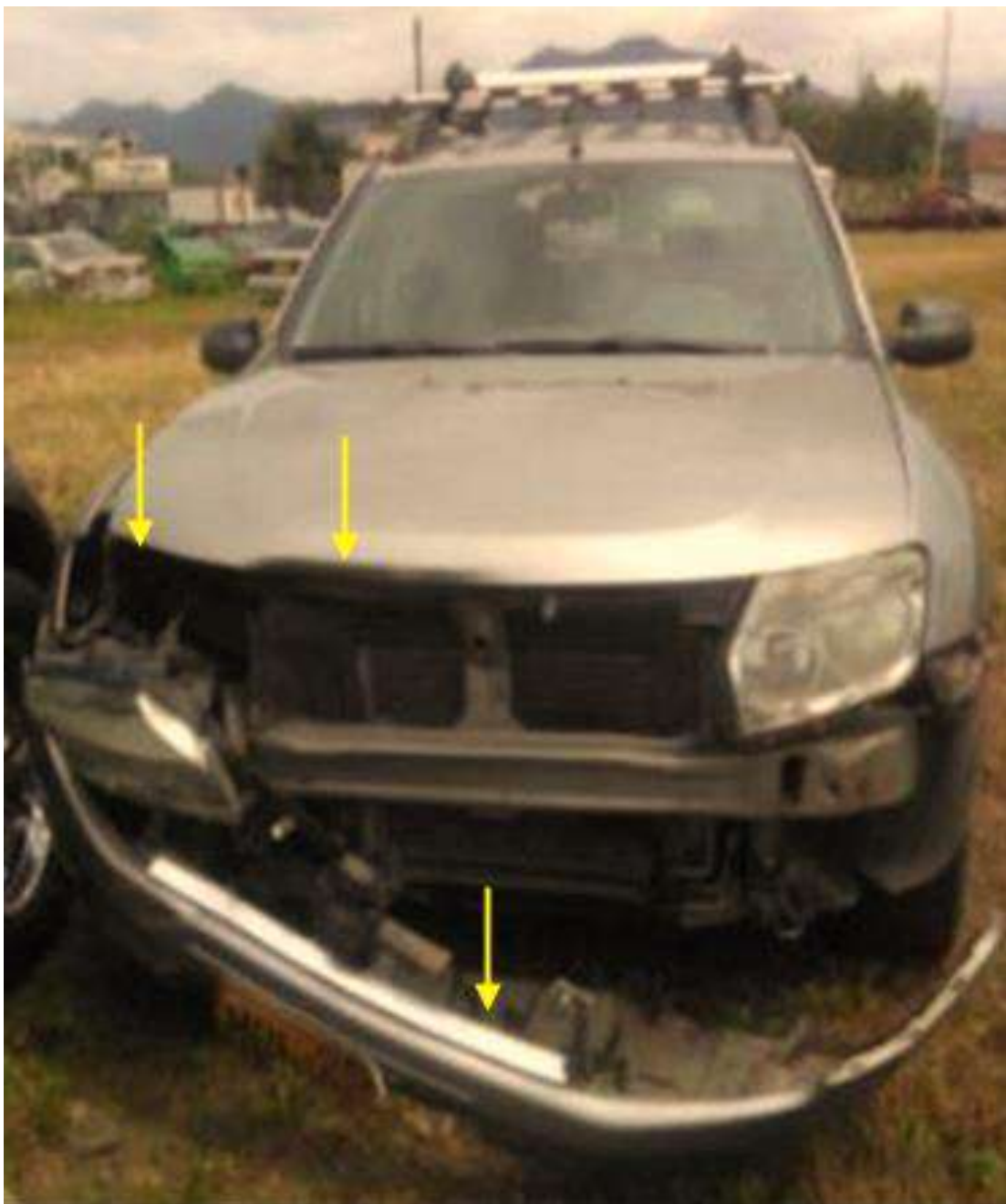
Imagen No. 9: En esta imagen aportada para el análisis del caso se observa el estado final de la zona frontal del vehículo No. 1, donde se evidencia que tiene afectación del capó, con desalojo de unidad de luz anterior derecha, bómper anterior y persiana.
