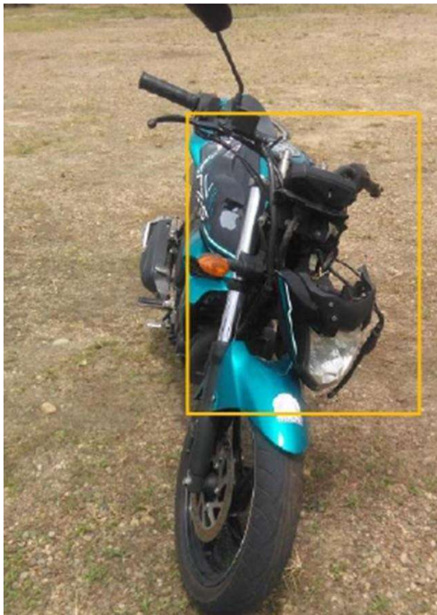
Imagen No. 13: En esta imagen se observa la región frontal del vehículo No. 2, se evidencia que tiene desalojo del carenaje anterior, con ausencia del espejo retrovisor izquierdo.
