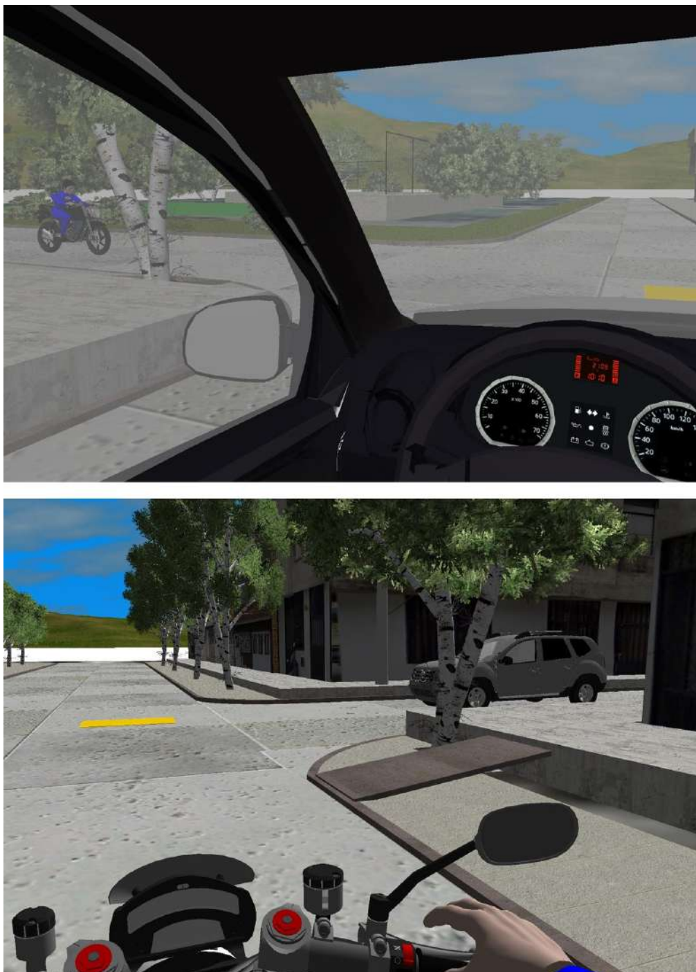
Imagen No. 31: En estas imágenes, se aprecia la visibilidad que tenían los conductores 1,35 s promedio antes del impacto.
