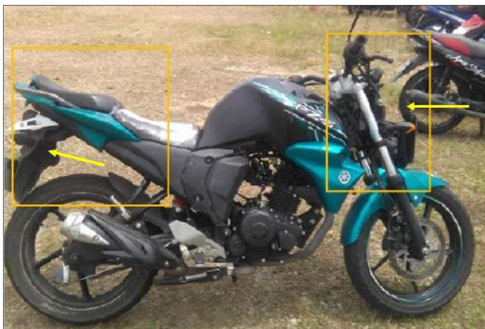
Imagen No. 16: En esta imagen se observa el estado final de la zona lateral derecha del vehículo No. 2, donde se evidencia el desplazamiento del guardabarro y el desalojo del carenaje anterior.
