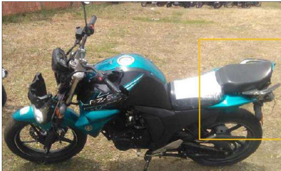
Imagen No. 15: En esta imagen se observa el estado final de la zona lateral izquierda del vehículo No. 2, donde se evidencia que tiene rotura de la tapa cola izquierda, stop y trasero.
