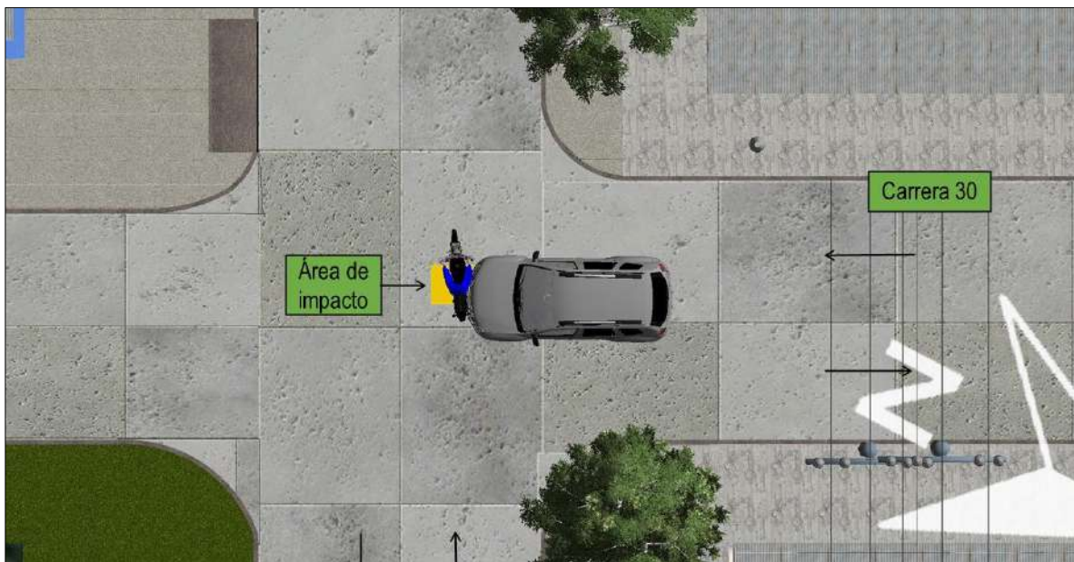
Imagen No. 23: En esta imagen vista en planta se muestra la posición relativa de los vehículos al momento del impacto y el área donde se presentó, elaborada en el software Trimble Forensic Reveal.
