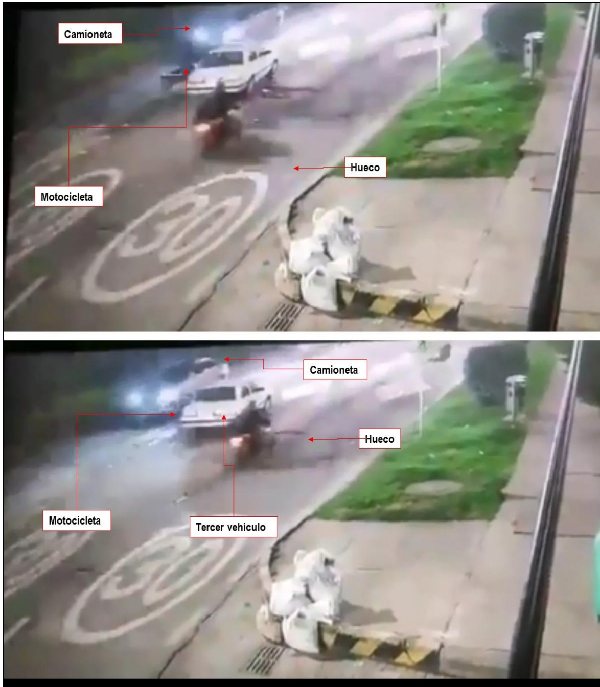
Imagen No. 26: En estas imágenes extraídas de un video de una cámara de seguridad se aprecian la secuencia pre impacto de los vehículos, más exactamente el momento de la pérdida de control de la motocicleta y su posterior caída al suelo.
