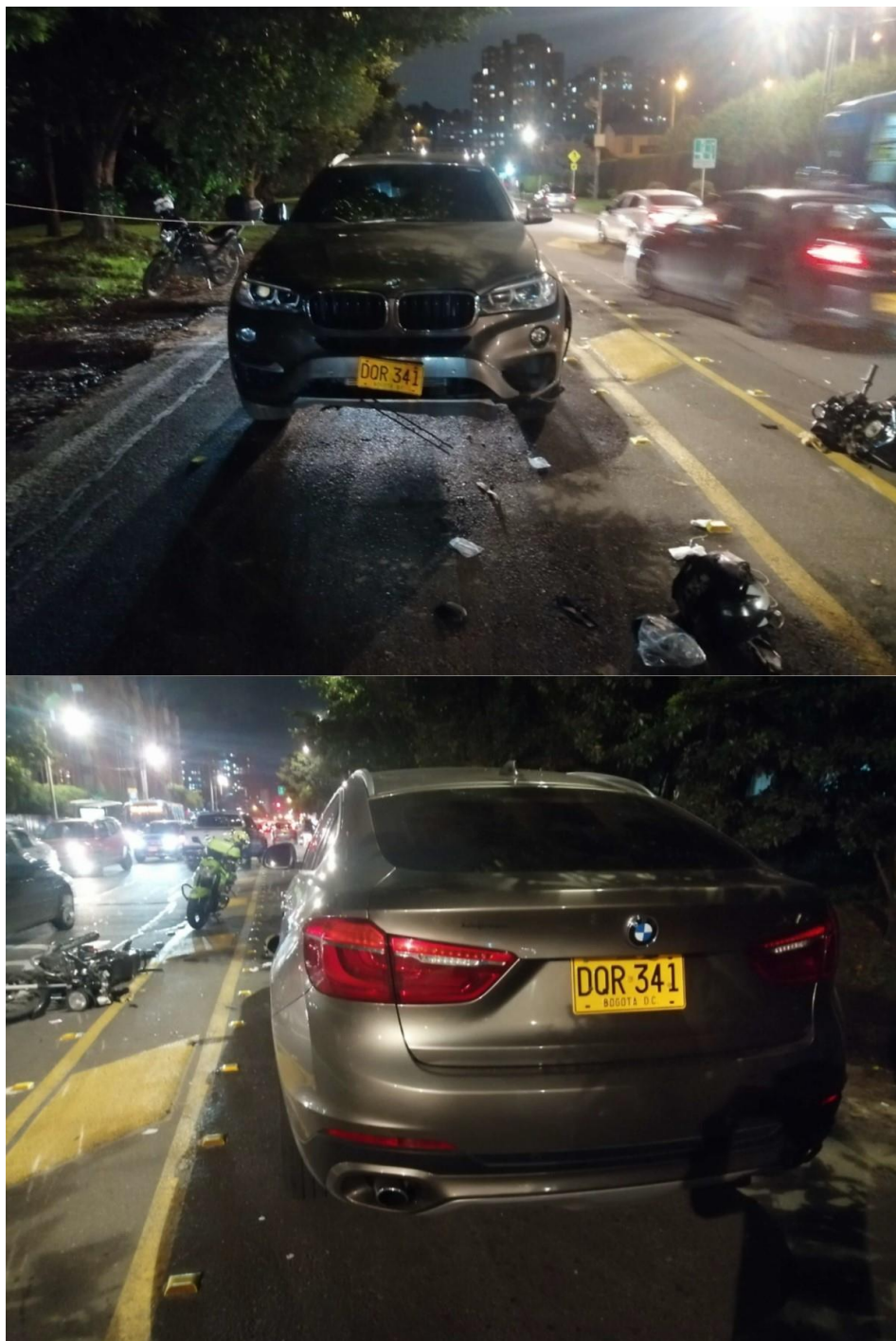
Fotografías No.15 y 16: Se observa la posición final de los vehículos involucrados en el accidente de tránsito, así mismos vestigios, huellas de arrastre presentes en la vía.
